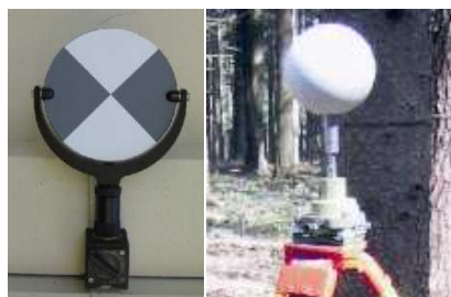
Figur 10- Två typer av måltavlor. Tillvänster är en så kallad "tilt and turn" tavla som gör måltavlan roterbar och synbar från olika skanningsuppställningar. Typ två är en sfärisk måltavla som också är synlig vid olika skanningsuppställningar (Leica Geosystems, 2013a; Van Ganechten, 2008).
