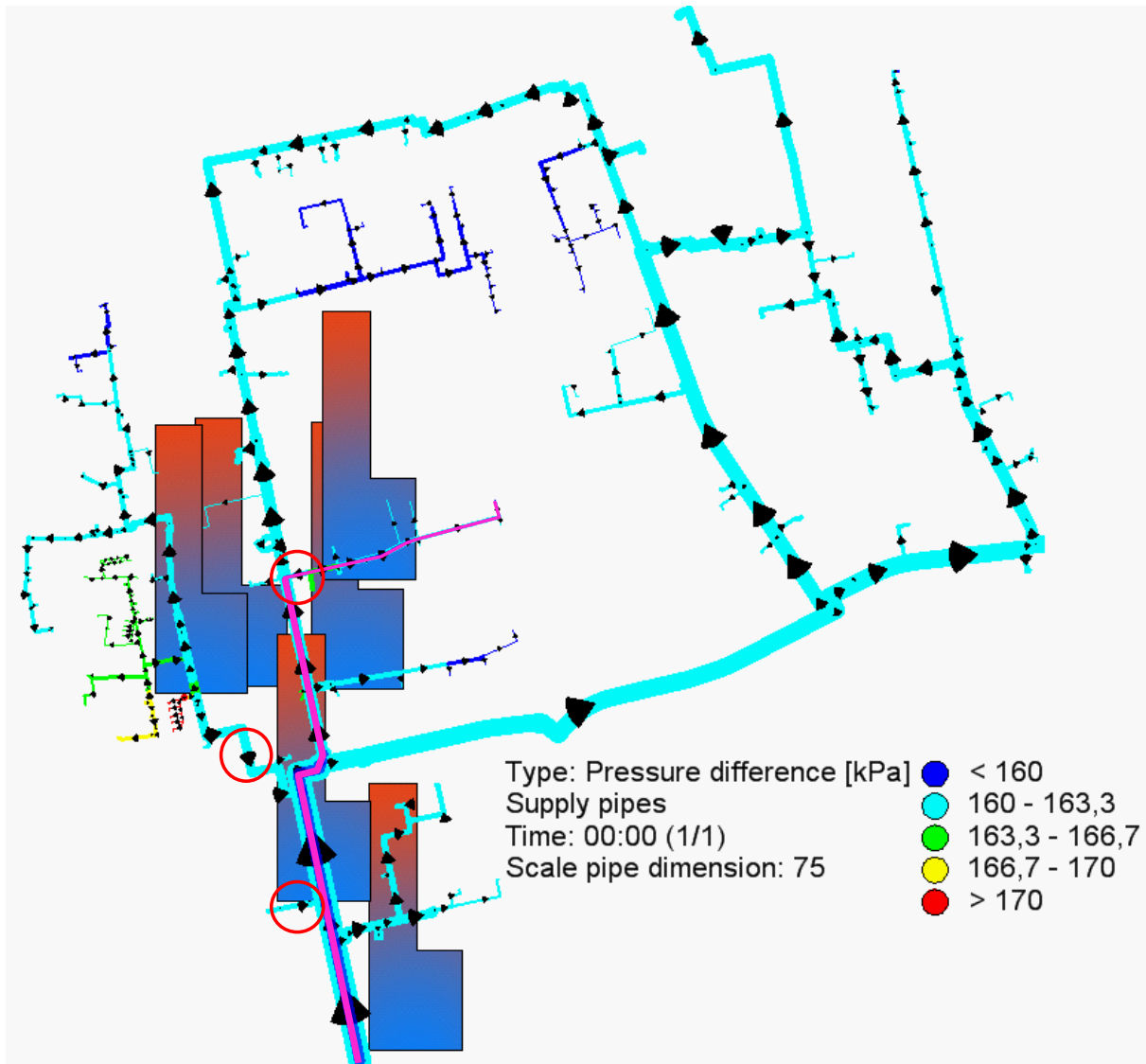
Figur 46. Differenstryck vid säsongsfall Max och produktionsfall Mast. Rosa linje beskriver vilken sträcka som tryckkonerna i figur 47 och 48 avser. Svarta pilar beskriver flödets riktning. De röda ringarna markerar att solfångaranläggningarna i Masthusen, Bo01 och på Kockum Fritid levererar ut värme till andra områden i Västra Hamnen.
