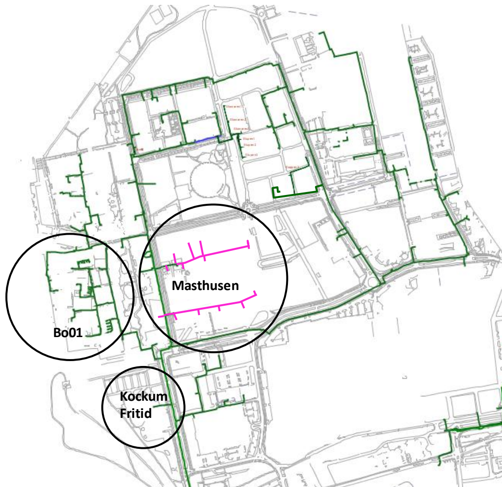
Figur 4. Fjärrvärmenätet i Västra Hamnen. De svarta cirklarna markerar områdena Masthusen, Bo01 och Kockum Fritid. Ett förslag på hur det framtida fjärrvärmenätet i Masthusen kan se ut är inritat med rosa linjer i den största cirkeln.
