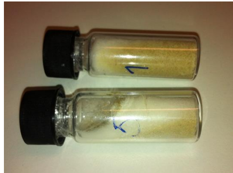
Figur 18. Ett prov med i 6 % fibermaterial efter inkubering i 60°C i 120 minuter, sedimentering och frystorkning
