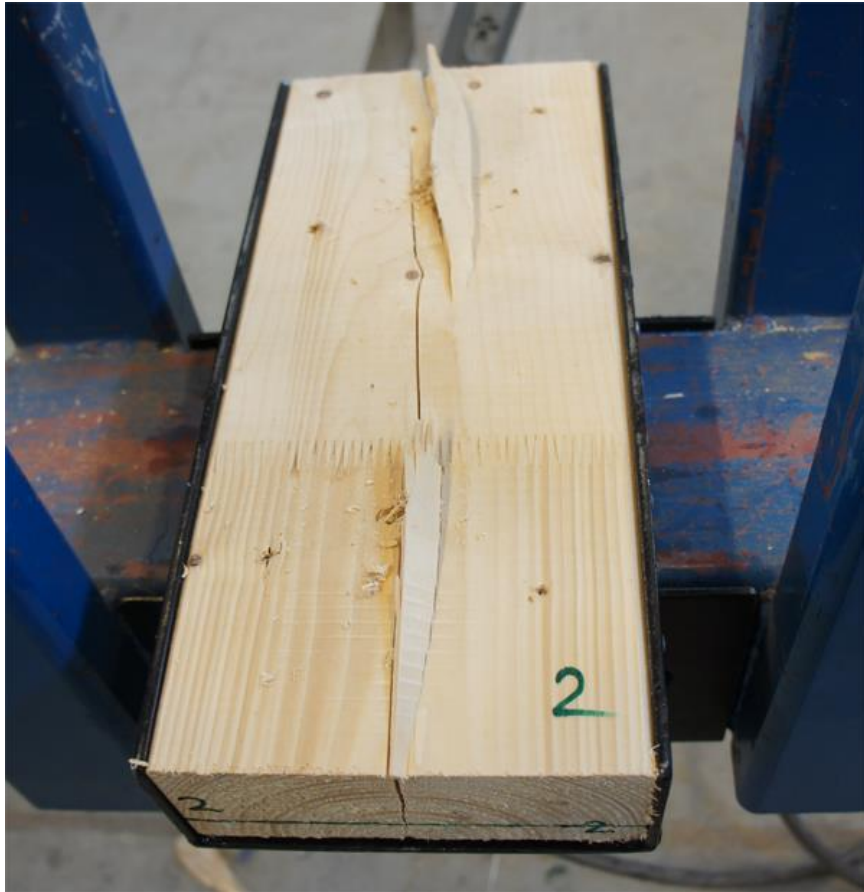
Figur 7.5: Sprucken regel från provkropp 02.
