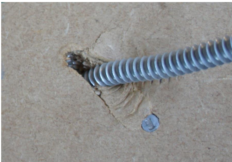
Figur 7.12: Deformationer i MDF-skiva på provkropp 06.
