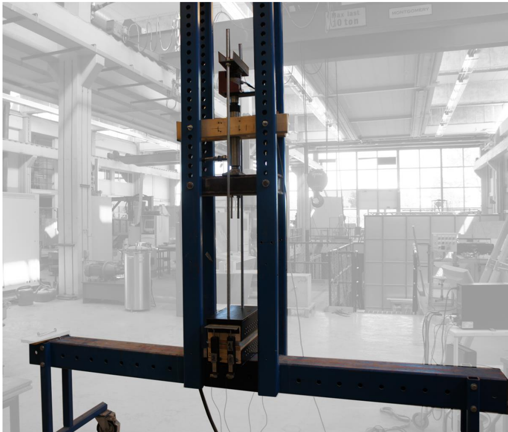
Figur 7.2: Provrigg för dragprov med monterad provkropp.
