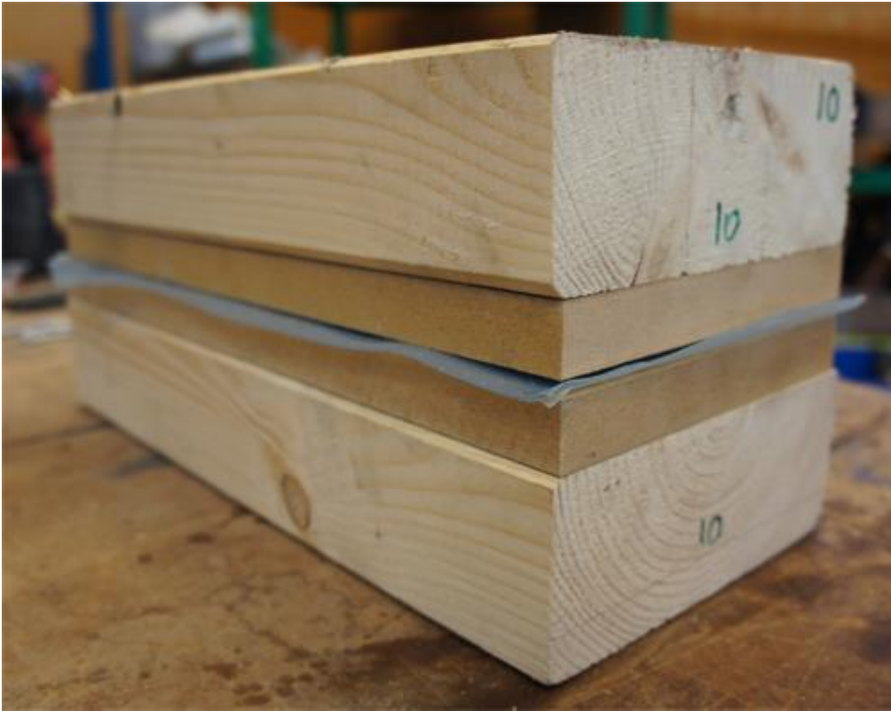
Figur 7.1: Provkropp 10 för dragprov.
