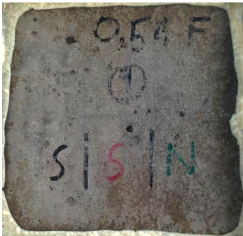
Figur 5.7 – Provkropp med formyta och vct 0,54 efter provningsvecka 1.
