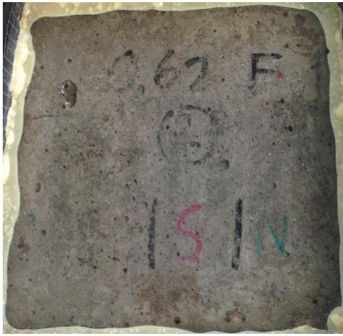
Figur 5.5 – Provkropp med formyta och vct 0,62 efter provningsvecka 1.
