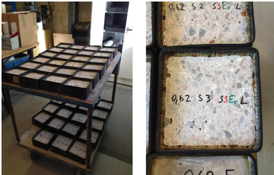
Figur 4.11 - Provkroppar innan experimentet startades.
