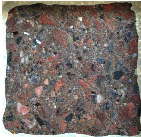
Figur 5.4 – Provkropp med sågad yta och vct 0,54 efter provningsvecka 4.
