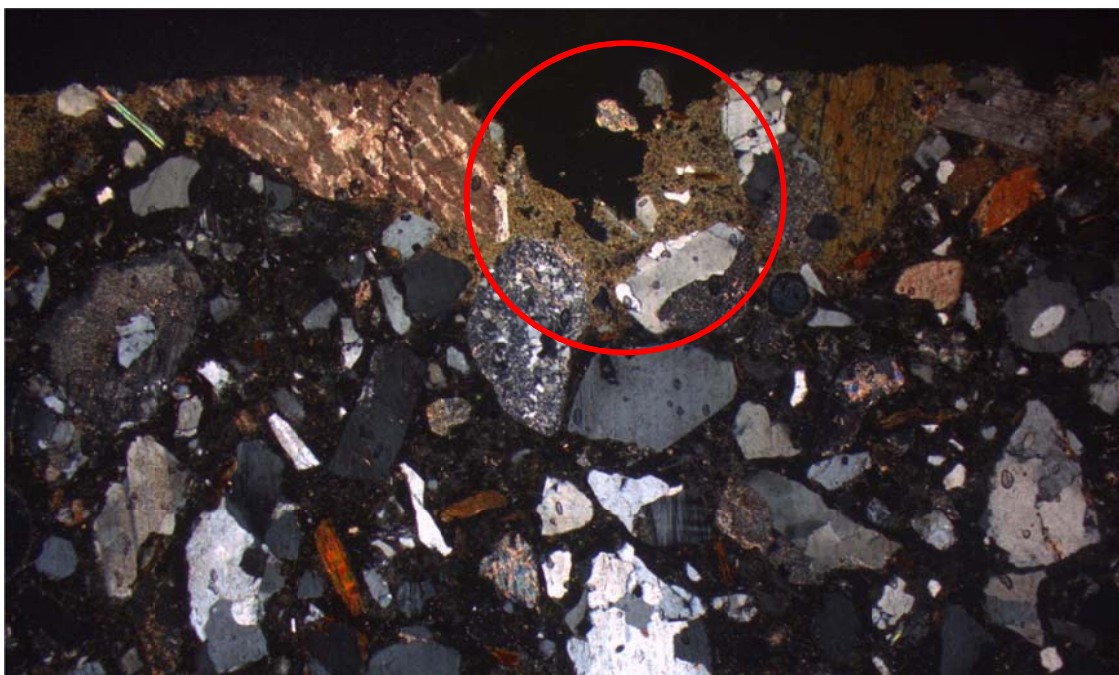
BILD 12. Karbonisering ca 0,8 mm ner i provet (mörkfält). Bildbredden motsvarar 6,7 mm
