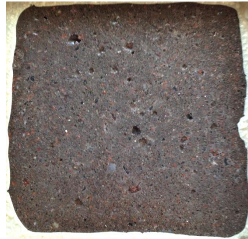
Figur 5.8 – Provkropp med formyta och vct 0,54 efter provningsvecka 4.
