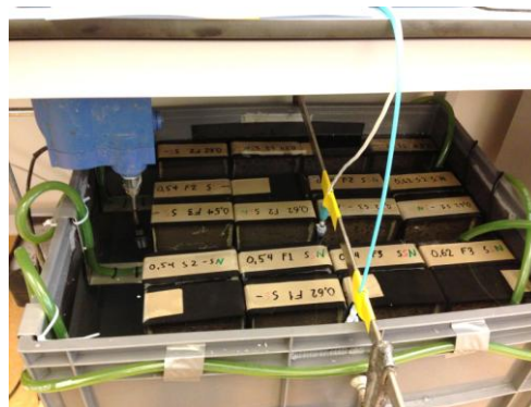
Figur 4.6 - Placering av mixer, pH-mätare samt doseringslang.
