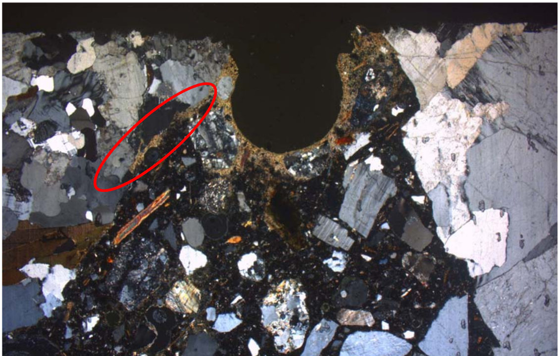
BILD 10. Samma område som i BILD 9 avbildat i mörkfält. Bildbredden motsvarar 6,7 mm.
