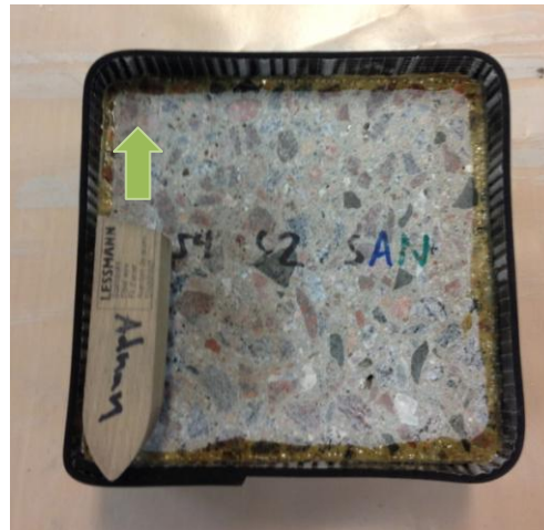
Figur 4.8 - Val av nötningssätt. Varje vertikal del nöttes fram och tillbaka 10 gånger.
