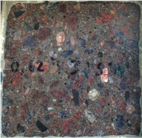
Figur 5.1 – Provkropp med sågad yta och vct 0,62 efter provningsvecka 1.
