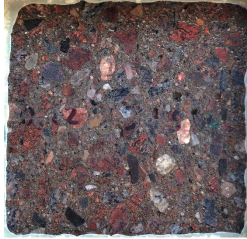
Figur 5.2 – Provkropp med sågad yta och vct 0,62 efter provningsvecka 4.
