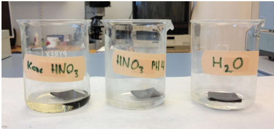
Figur 4.9 - Uppställning av experiment. Kvadratiske bitar med sida 3 cm placerade i 20 ml lösning med olika pH. Bägarnas öppning täcktes sedan med avdunstningsskydd.
