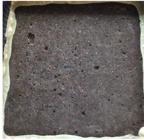
Figur 5.6 – Provkropp med formyta och vct 0,62 efter provningsvecka 4.
