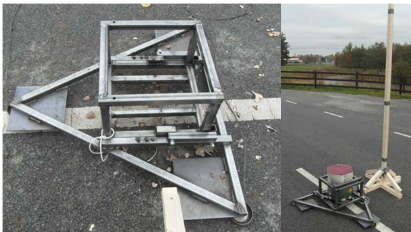
Figur 13 – Ställningen uppställd på lastceller bredvid trästolpe som höjdsreferens.
