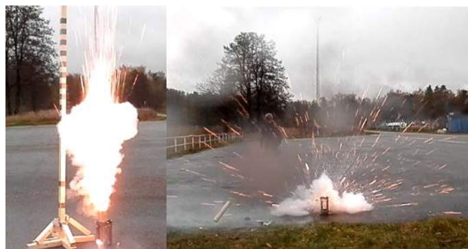
Figur 20 – Enkelrör avfyrate uppåt- respektive nedåtvänt.
