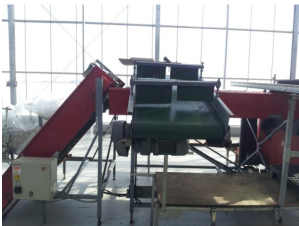
Figur 4. Sorteringsmaskin som sorterar tomaterna efter storlek och färg.
