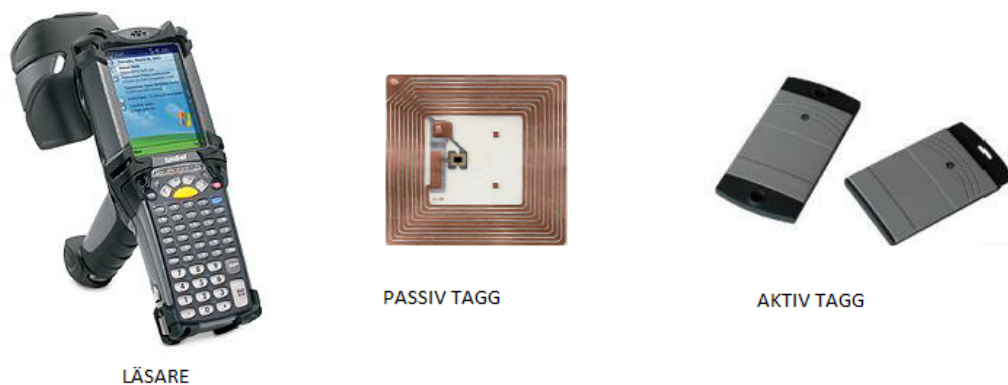
Figur 10, Exempel på läsare, passiv respektive aktiv tagg. (Taylor et al., 2008)
