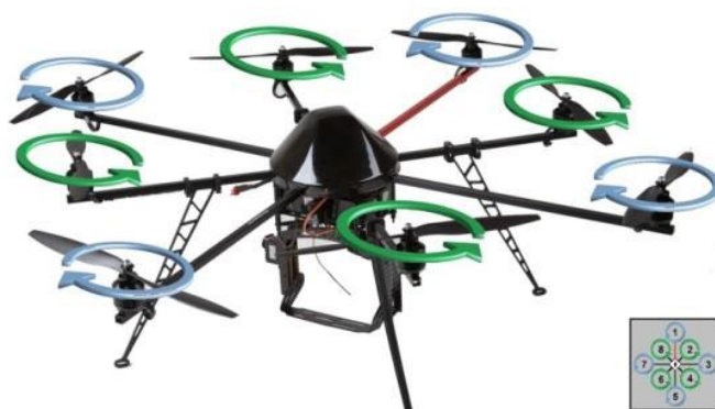
Figur 2.4 Motorerna på farkosten roterar åt olika håll
