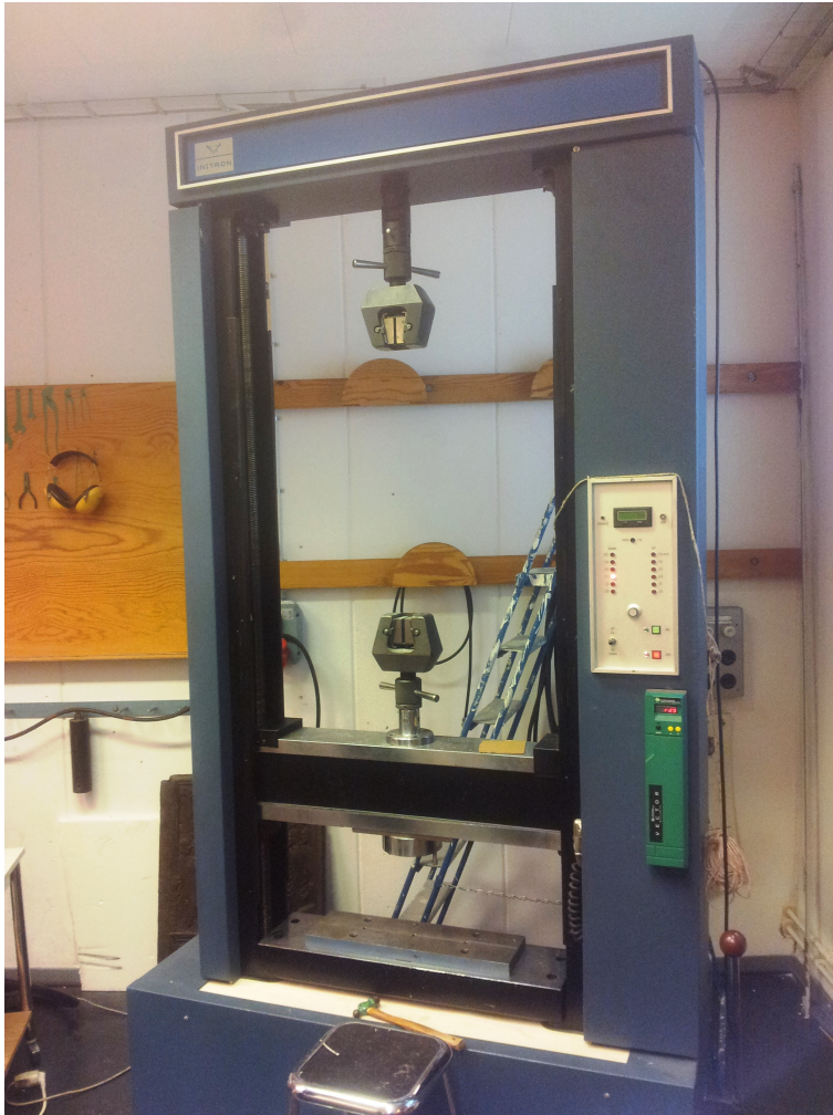
Figur 3.4: Fotografi av dragmaskinen Instron som användes vid provningen.
