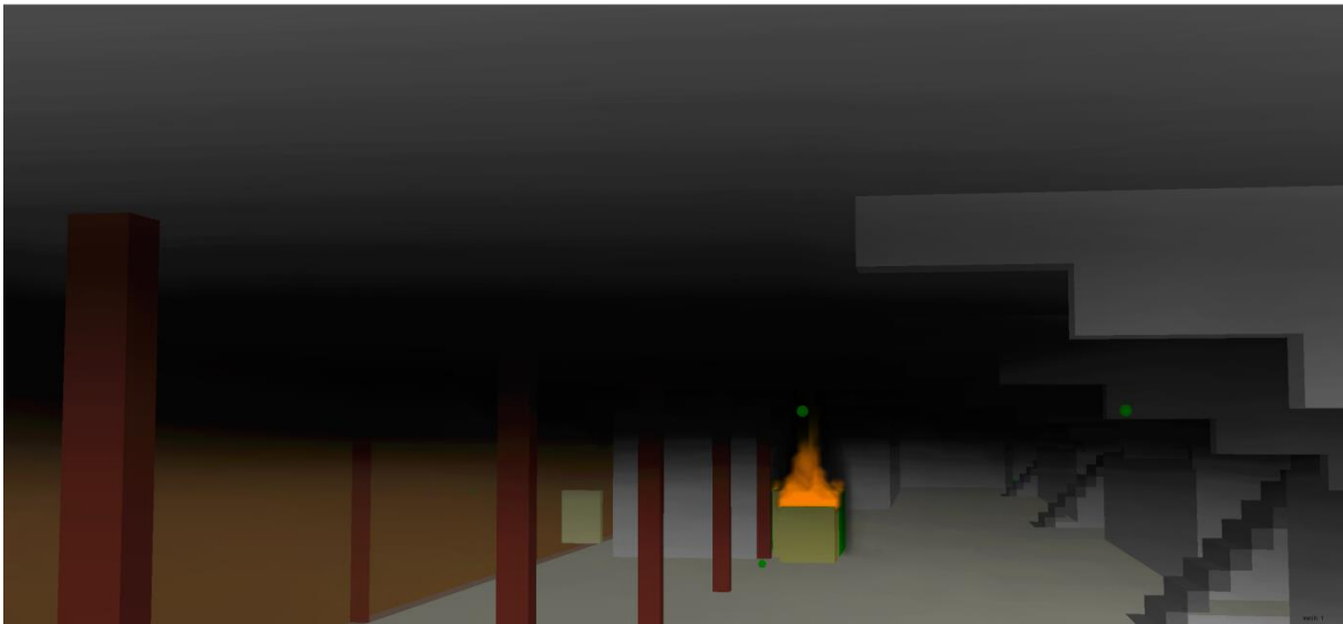
Figur 25. Visualisering i smokeview på mellanplan vid tiden för kritiska förhållanden här, 90 sekunder.
