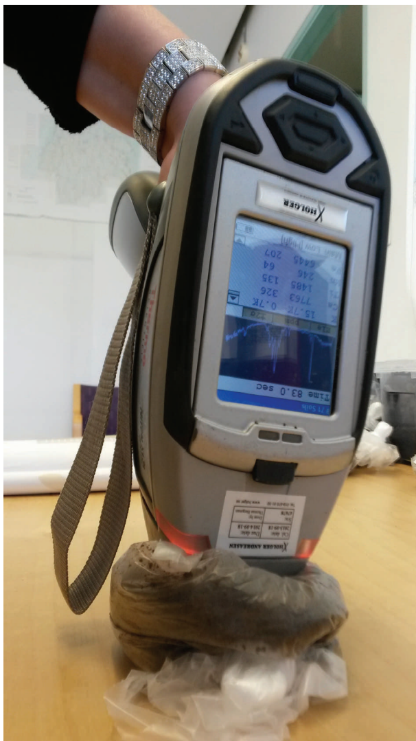
Fig. 11. XRF-mätning på jordprov från Rejmyre (foto: A. Helmfrid).
