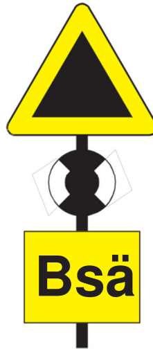
Fig 5. Orienteringstavla för infartssignal
