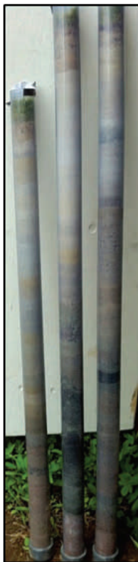
Fig. 9. Materialprover från borrhning. Från vänster: B1, B6 och B5. 0 meter (markytan) är överst i respektive rör.
