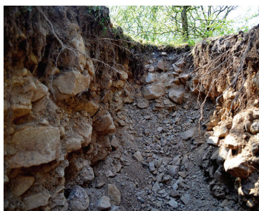
Fig. 10. Grävt dike mellan B1 och B6. Riklig förekomst av grus, sten och block förekommer i jordlagren.
