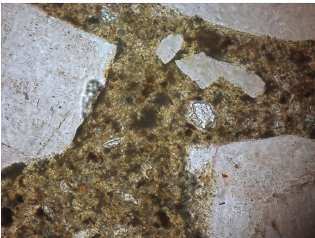
Bild 12. Prov A/60, tunnslip 4025, planpolariserat ljus. Området i bilden är 0,4 mm brett.
