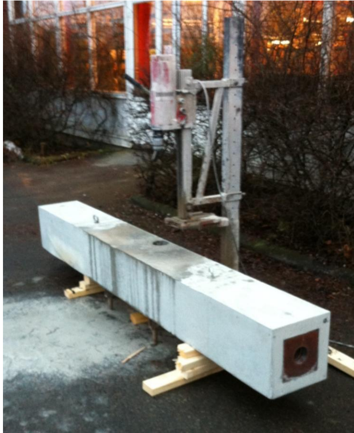
Bild 4.1 - Utbörning av prover från Lundqvist (2012) balk
