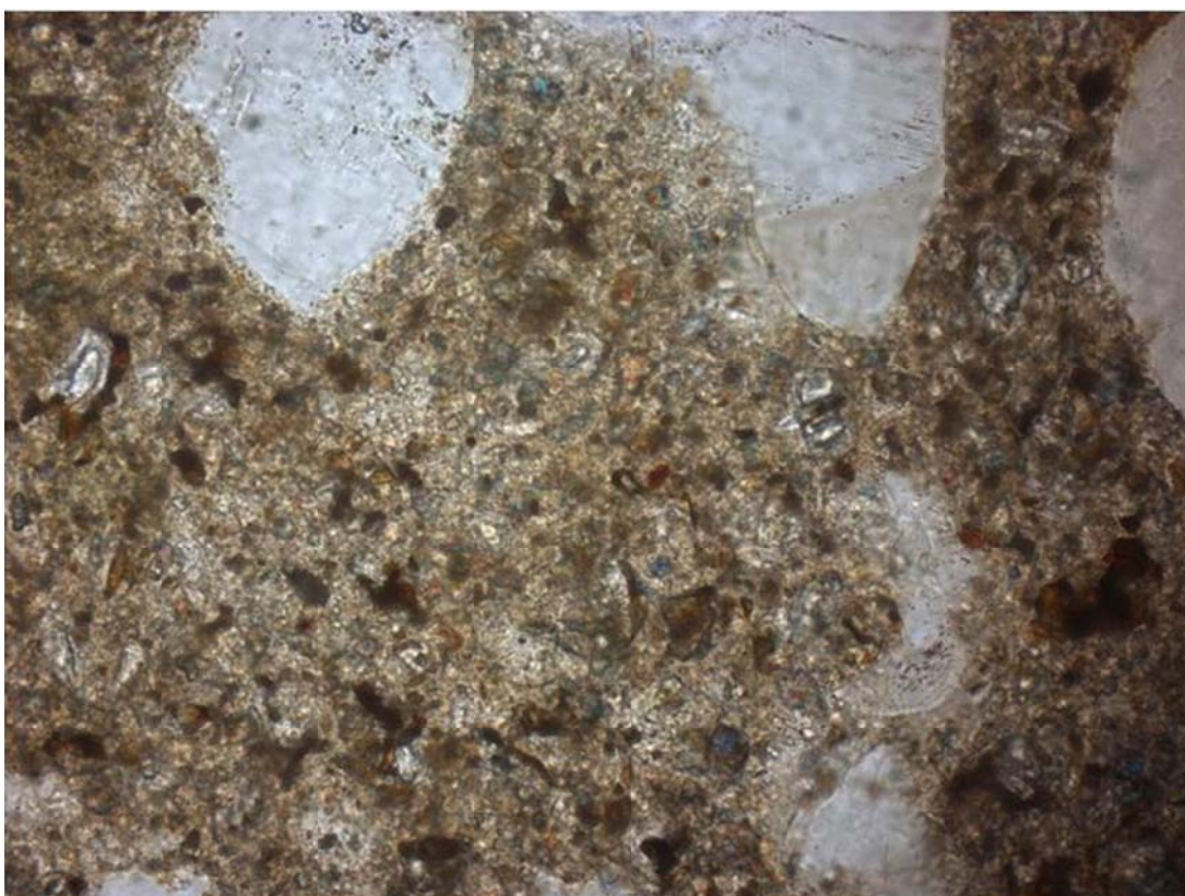
Bild 6. Prov A/20, tunnslip 4024, planpolariserat ljus. Området i bilden är 0,4 mm brett.
