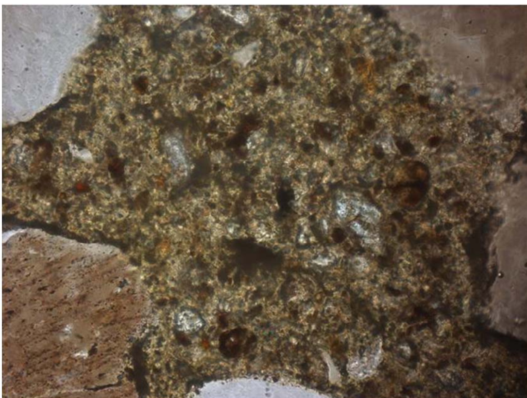
Bild 22. Prov A/90, tunnslip 4027, planpolariserat ljus. Området i bilden är 0,4 mm brett.
