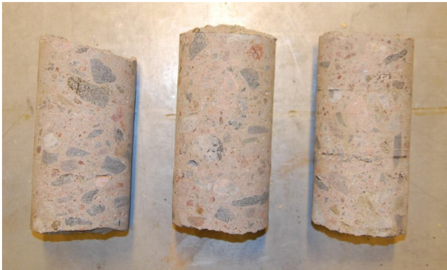
Bild 4.2 - Kärnbörpröver från Olkiluoto-balkar
