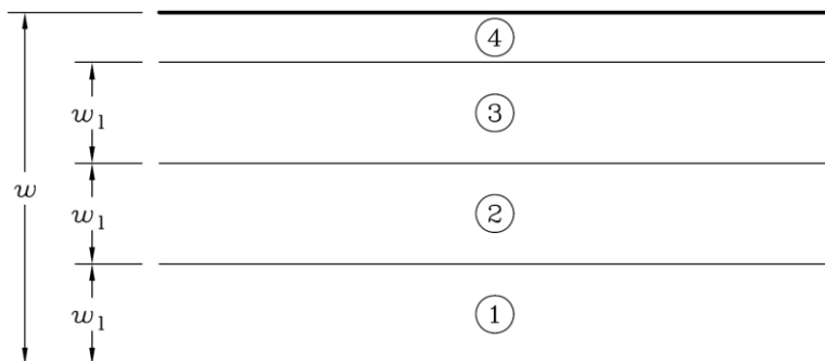
Figur 2.2. Numrering av lastfält. I detta exempel numreras lastfälten 1-3 medan den återstående ytan är nr. 4 (SS-EN 1991-2:2003, Figur 4.1).
