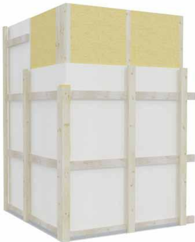
Figur 2.6. Montering av läkt (Knaufdanogips, 2012)
