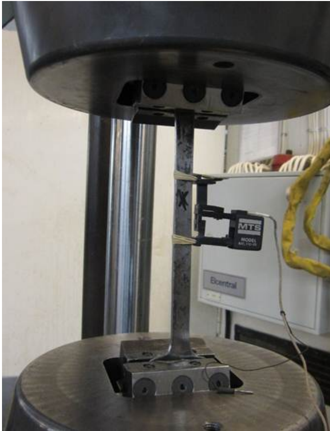
Figur 17 Utförandet på dragprovet gick till enligt följande.
