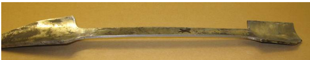
Figur 16 Provbiten för dragprovet såg ut enligt följande.
