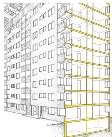
Bild 3: Skivhus av fasadelement
