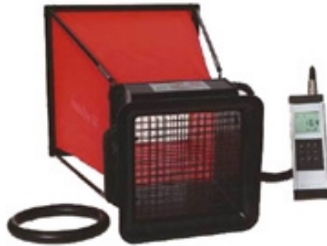
Figur 3 Stosen SwemaFlow 125 och mätinstrumentet SwemaAir 300 har använts vid mätning av till- och frånluftflöde.
