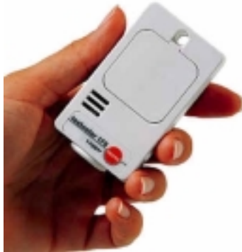
Figur 1 Termohygrografen Testostor 175-2 har använts vid mätning av lufttemperatur.
