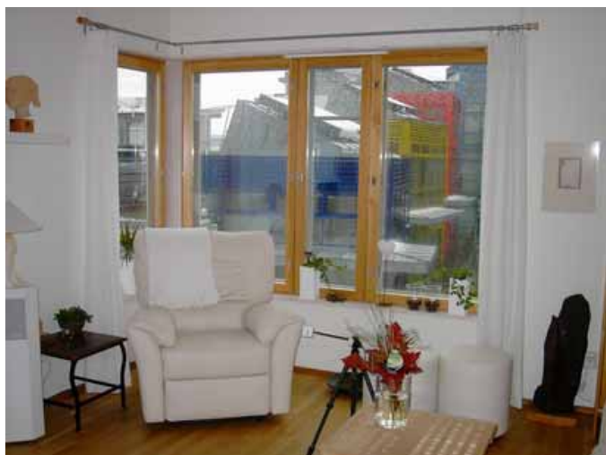
Figur 7. Operativ temperaturmätning med kubtermometer i en av lägenheterna
