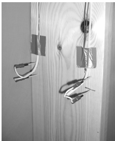
Figur 3.6: Stift för mätning av träfuktkvot i regelstomme
