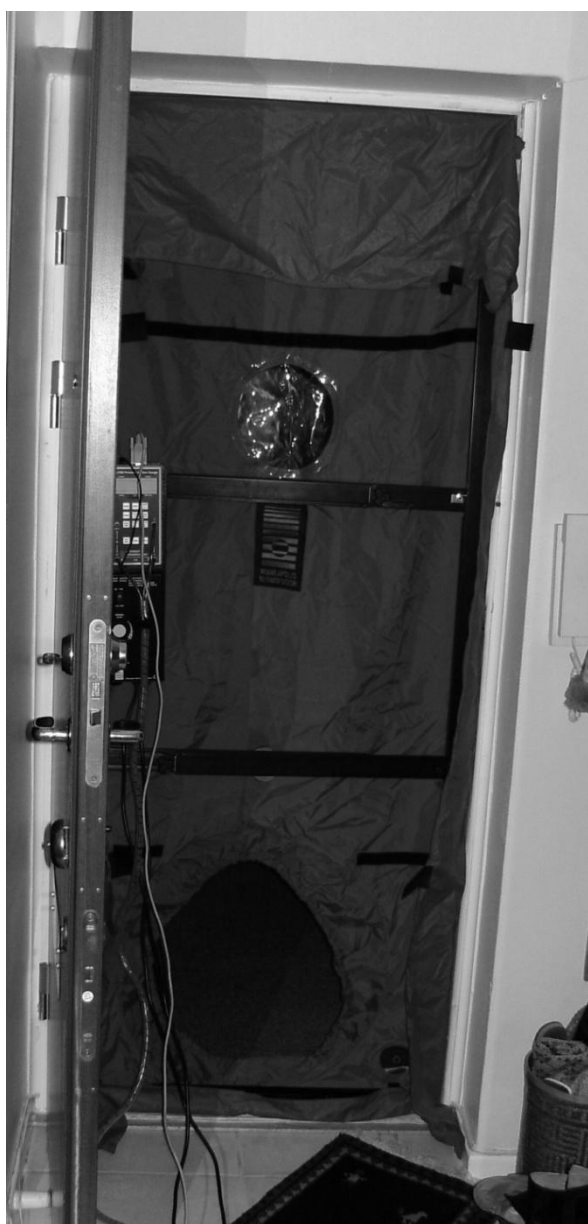
Bild 7 och 8 visar tryckprovningens utrustning innan fläkten monterades in i hålet i underkant och sedan fläkten monterad.
