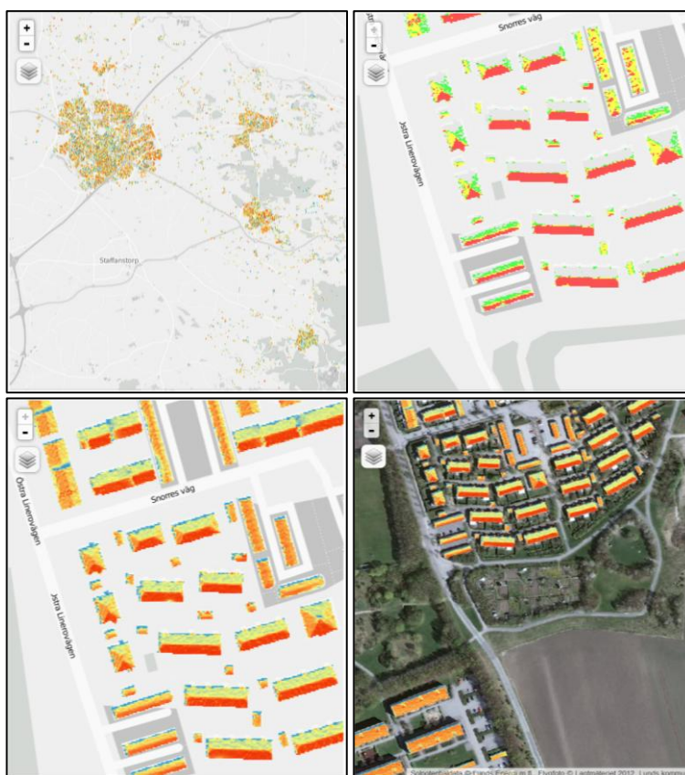
Figur 14. Fyra sätt att se solpotentialen via internetapplikationen: Uppe till vänster, en utzoomad bild över hela området med karta som bakgrundsbild. Uppe till höger, en inzoomad bild över ett område som visar kategoriserad instrålning. Nere till vänster, ett område med glidande färgskala. Nere till höger, ett område med glidande färgskala och ortofoto som bakgrund.
