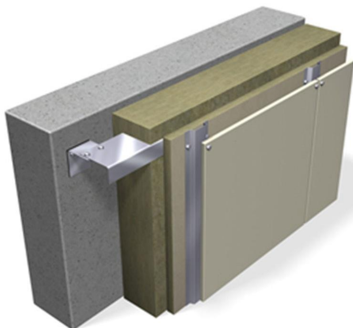
Figur 30. Tilläggsisolerad yttervägg från Paroc
