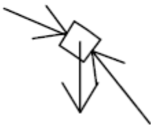
Figur 3.10: a) Stenvalv. b) Ett isolerat stenblock med utritade krafter. c) Jämvikt.
