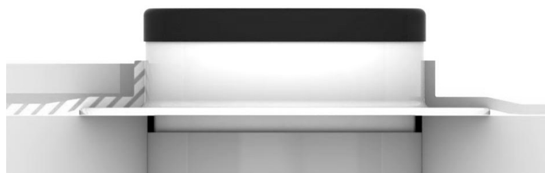
Figur 21. Anslutningen av plastmattan mot WC-stos med 15mm uppvik (Säker Vatten, 2011).
