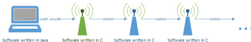
Figur 16: Typ av mjukvara på de olika delarna i systemet
