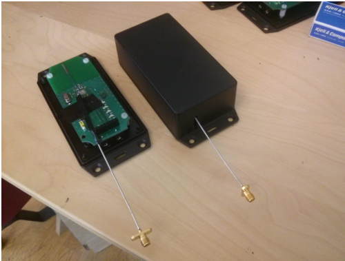
Figur 10: De två modulerna anpassade för mätning av radiodel
