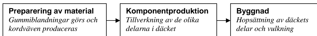
Figur 19: Översikt av produktionsprocessen av däck.
