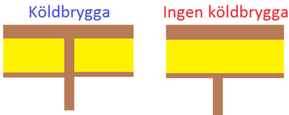
Figur 5.10 Innervägg ansluts till den nya väggen för att undvika en köldbrygga (A.Månsson).
