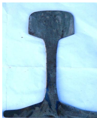
Figur 5: Räl visad i tvärsnitt.
