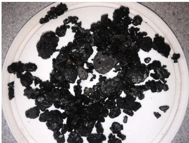
Fig. 9: Kaxprov från borrhningen i Södra Sandby som innehåller svarta och enstaka mörkgrå skifferflakor, samt enstaka pyritkorn. Plastlocket har en diameter på ca 9 cm.
