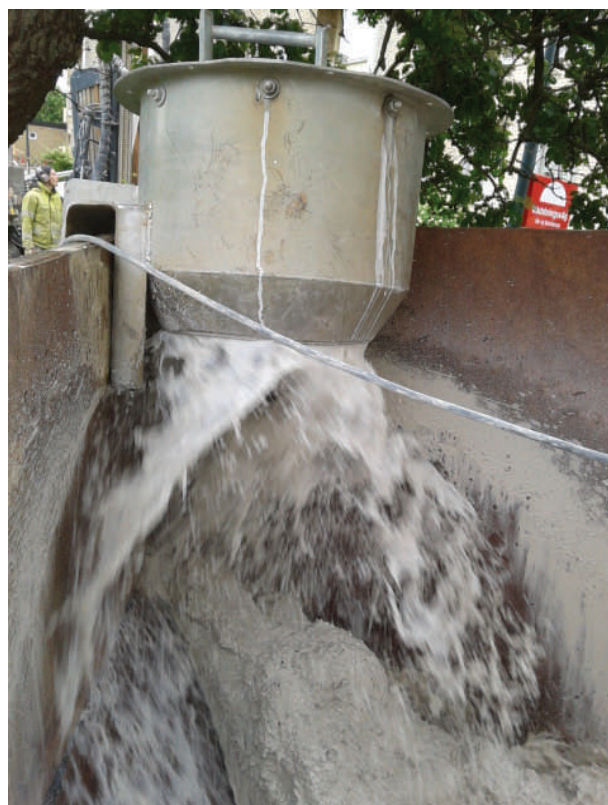
Fig. 20: Cyklon avsedd att bromsa det inkommande kaxvattnet samt avskilja tryckluften.
