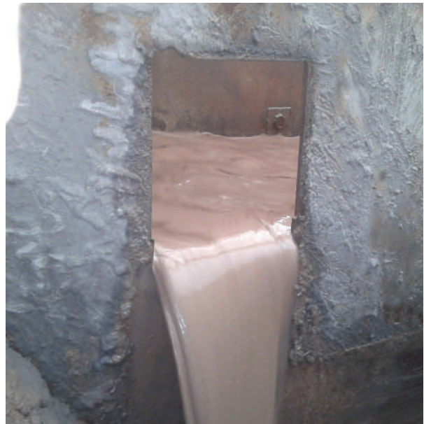
Fig. 11: Osedimenterat kaxvatten som rinner från det första facket till det andra facket i en första container.
