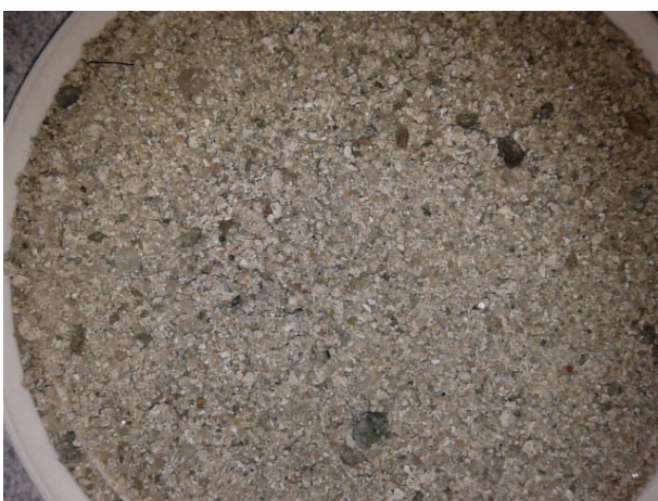
Fig. 11: Kaxprov från den dominerande litologin vid borrhningen i Kristianstad. Det innehåller kvartspartiklar med kalcitcement samt enstaka skalfragment och kalkhaltiga siltstenar. Plastlocket har en diameter på ca 9 cm.
