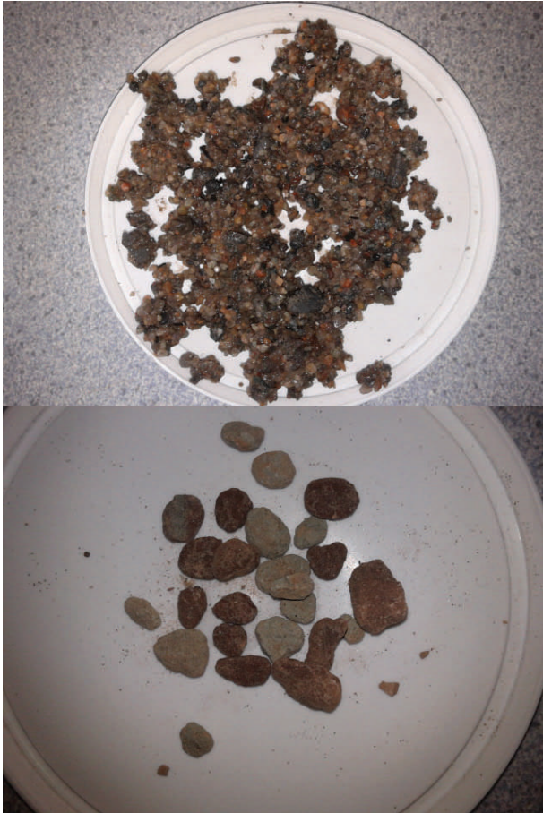
Fig. 10: Kaxprov från borrhningen i Mörap från löst konsoliderad arkos, med fragment av grå och enstaka rödbruna siltstenar (ovan). Torkade rödbruna och gröna siltstenar (nedan). Plastlocken har en diameter på ca 9 cm.
