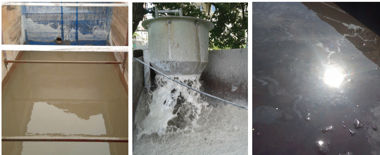
Fig. 3: Kaxvatten från borrhningar i arkos och siltsten (t. v.), kalksten (m) och alunskiffer (t. h.).
