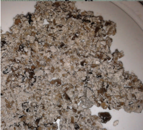
Fig. 12: Kaxprov från den borrhningen i Malmö. Ovan: Hård, grå, finkornig kalksten (från cirka 20 m). Tolkad stratigrafi: Höllvikenformationen, Köpenhamnsledet. Nedan: Mjuk, smulig kalksten i små fragment med rikligt med flinta (från cirka 80 m). Tolka stratigrafi: Höllvikenformationen, Krusebergsledet. Plastlocket har en diameter på ca 9 cm.
