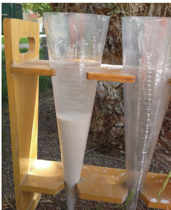
Fig. 4: Sedimentationskon som användes för uppskattning av halten suspenderat material.
