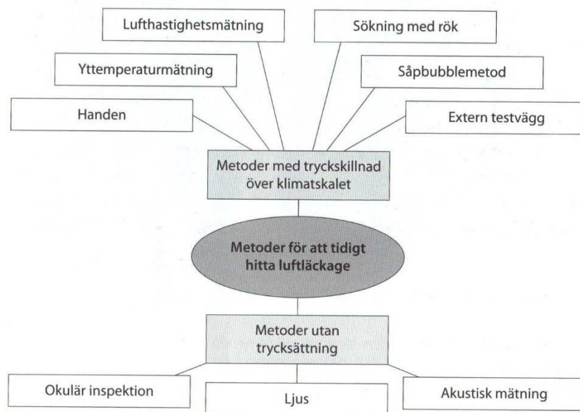
Figur 4-1 Metoder för att tidigt hitta luftläckage. (Bankvall, 2013)
