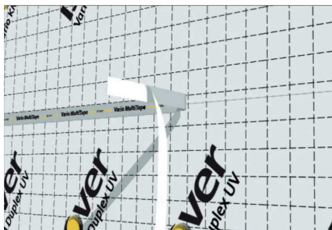
Figur 7-1 Tejpning av skarvar, (Isover, 2014)
