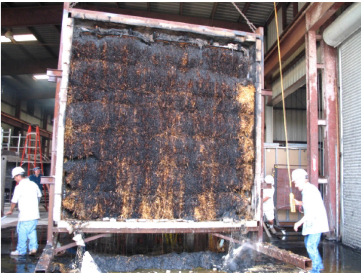
Figur 6: Halmbalsvägg efter brand- och vattenslangstest, Intertek (Intertek 2007).
