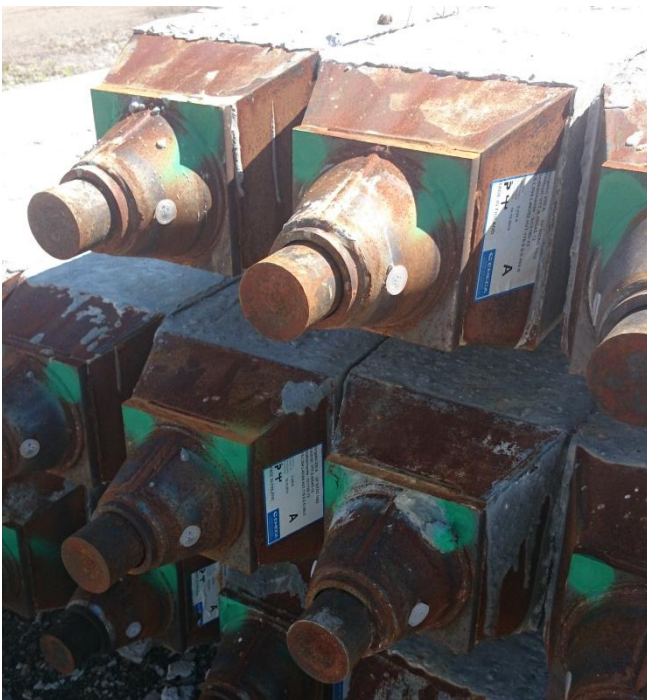
Figur 3.1 Bergsko för förankring till berggrund (Johansson 2014)
