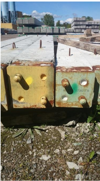
Figur 5.1 Pålar 275X275 mm respektive 235x235 mm.
