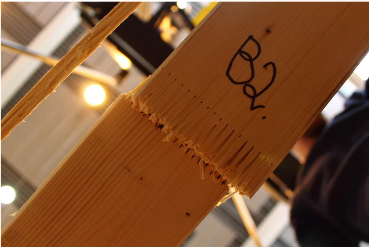
Figur 6.42 – Balk B2, underifrån, dragbrott i fingerskarv.
