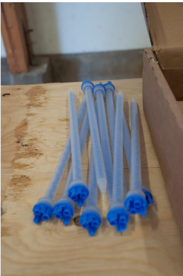
Figur 6.7 – Munstycken för blandning av lim och härdare.
