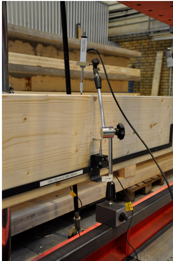
Figur 6.14- Givare för lokal och global nedböjning.
