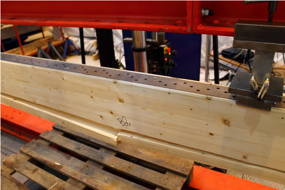
Figur 6.41. – Balk B2, dragbrott i fingerskarv.
