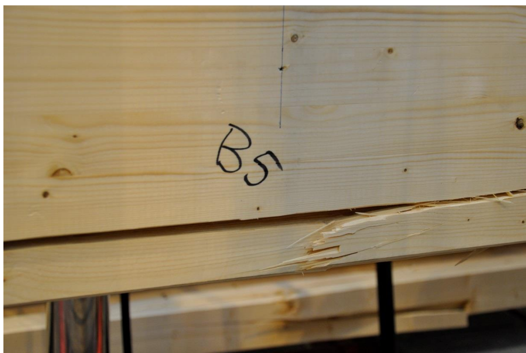
Figur 6.50- Balk B5, dragbrott i träet.
