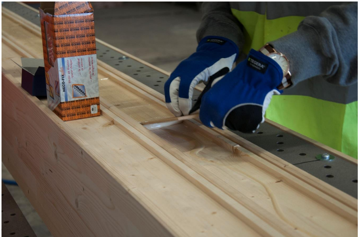
Figur 6.9 – Jämn fördelning av limmet på träytan.
