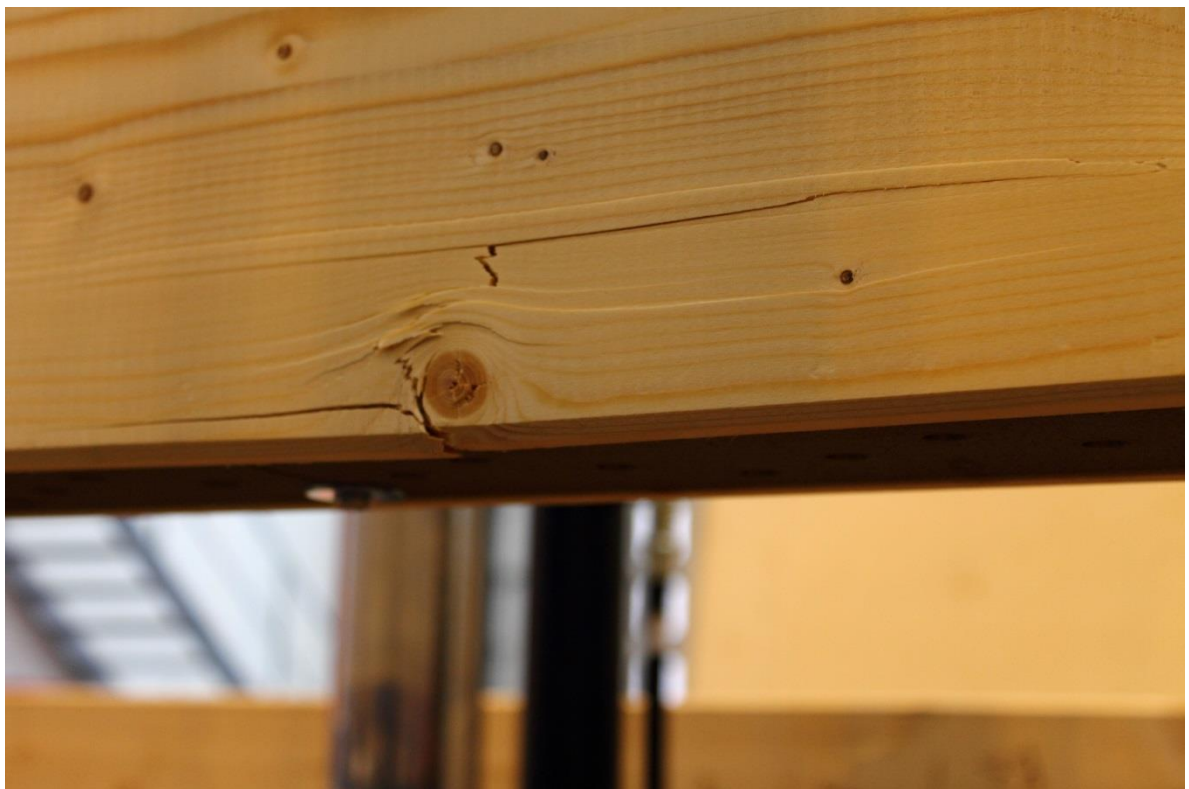
Figur 6.35 – Balk A4, dragbrott vid kvist.
