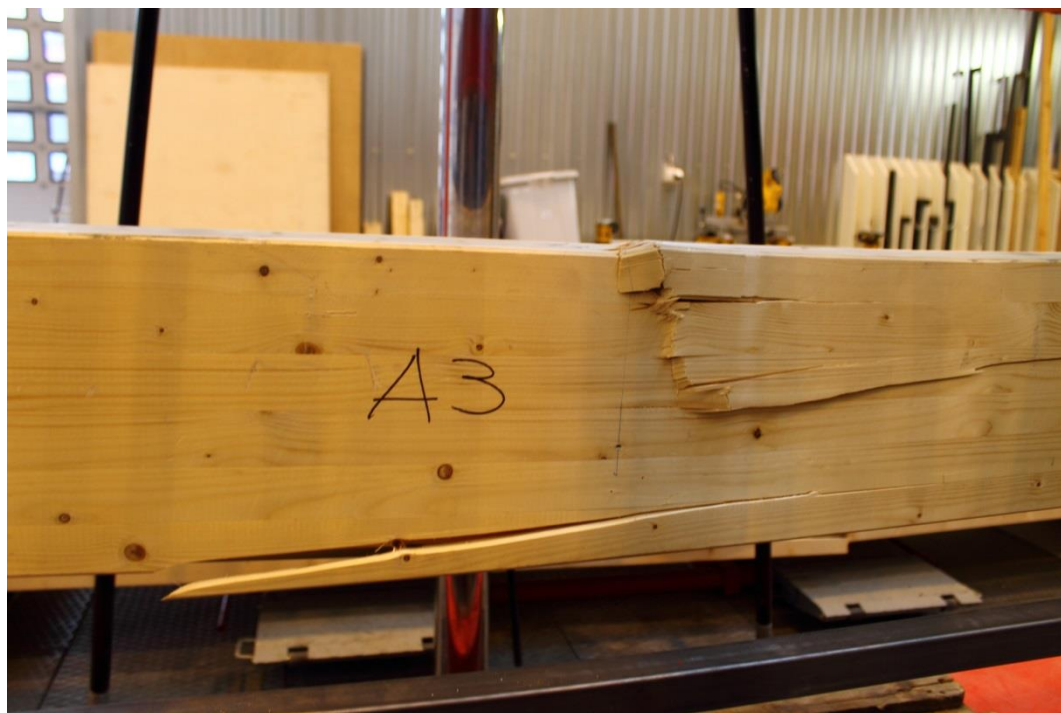
Figur 6.32 – Balk A3, tryckbrott i träet.
