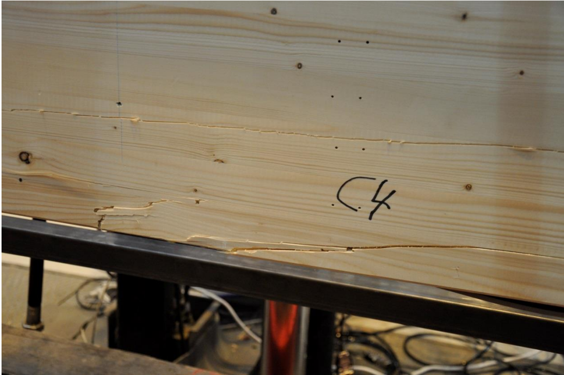
Figur 6.59- Balk C4, dragbrott i träet.
