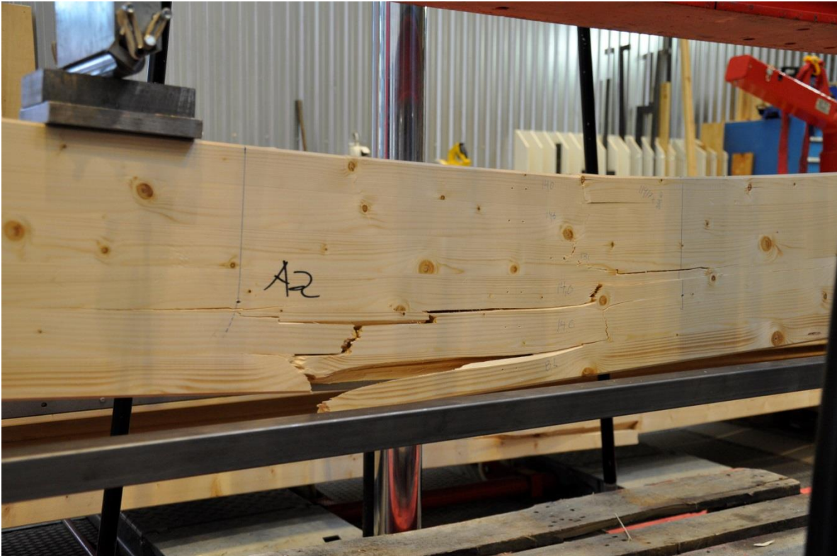
Figur 6.29 – Balk A2, drag och tryckbrott.
