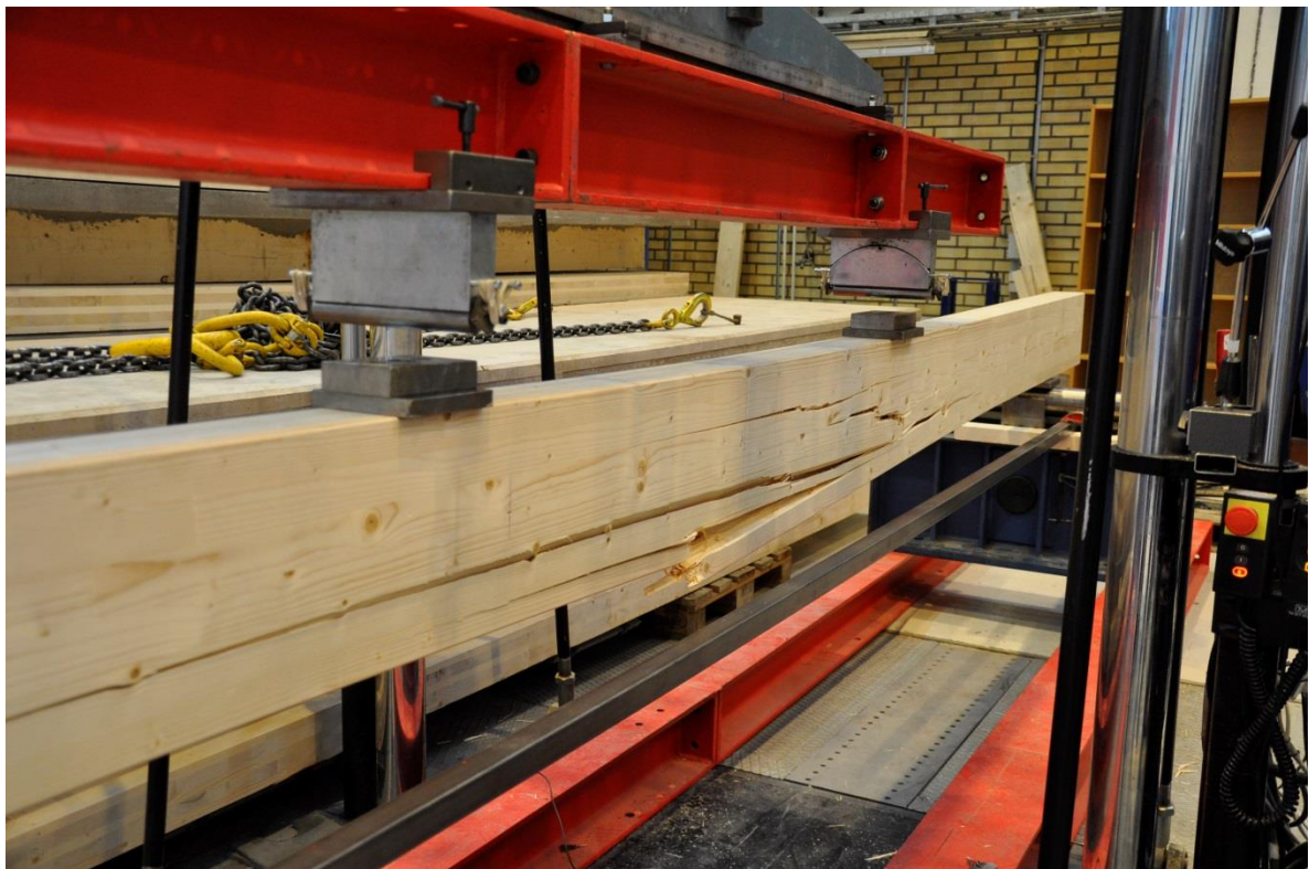
Figur 6.19 – Balk D1, dragbrott runt kvist.
