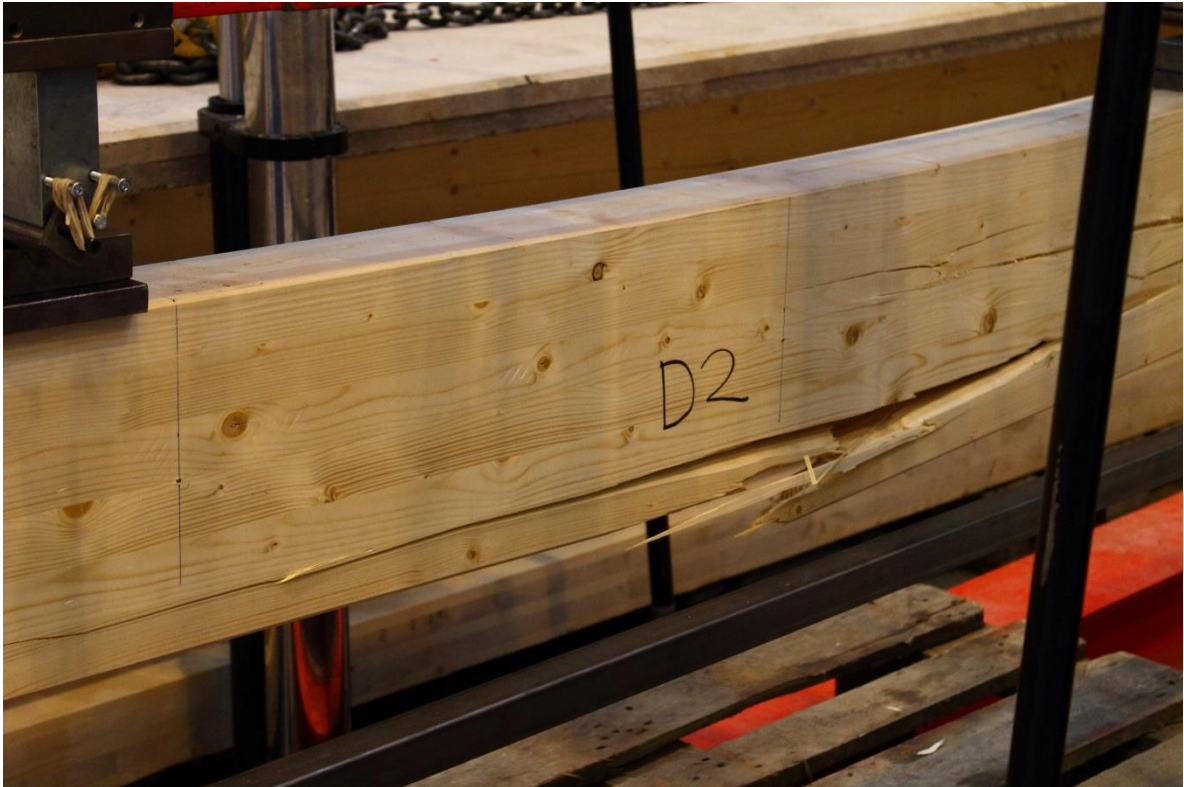
Figur 6.21 – Balk D2, dragbrott runt kvist.
