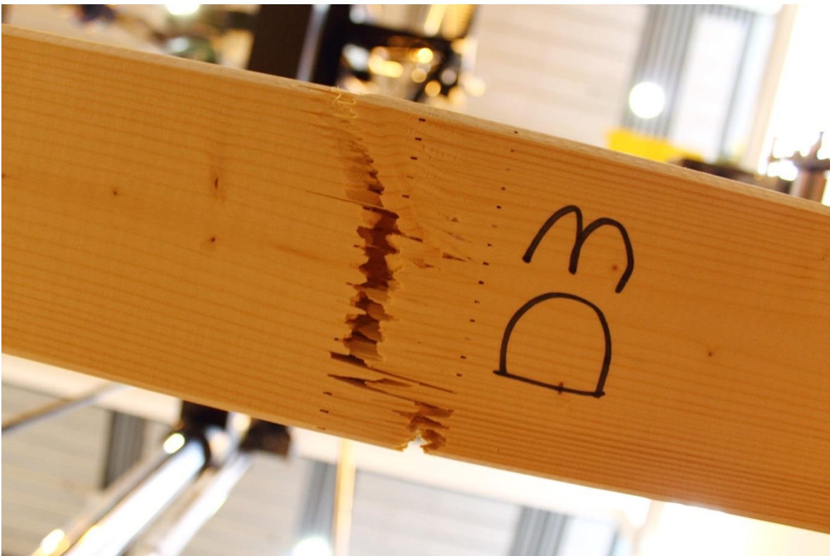
Figur 6.24 – Balk D3, underifrån, dragbrott runt fingerskarv.
