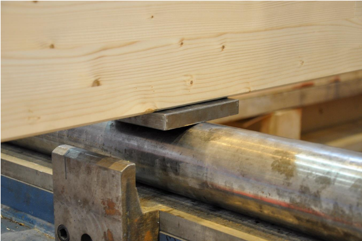
Figur 6.18- Metallplattor vid upplag.
