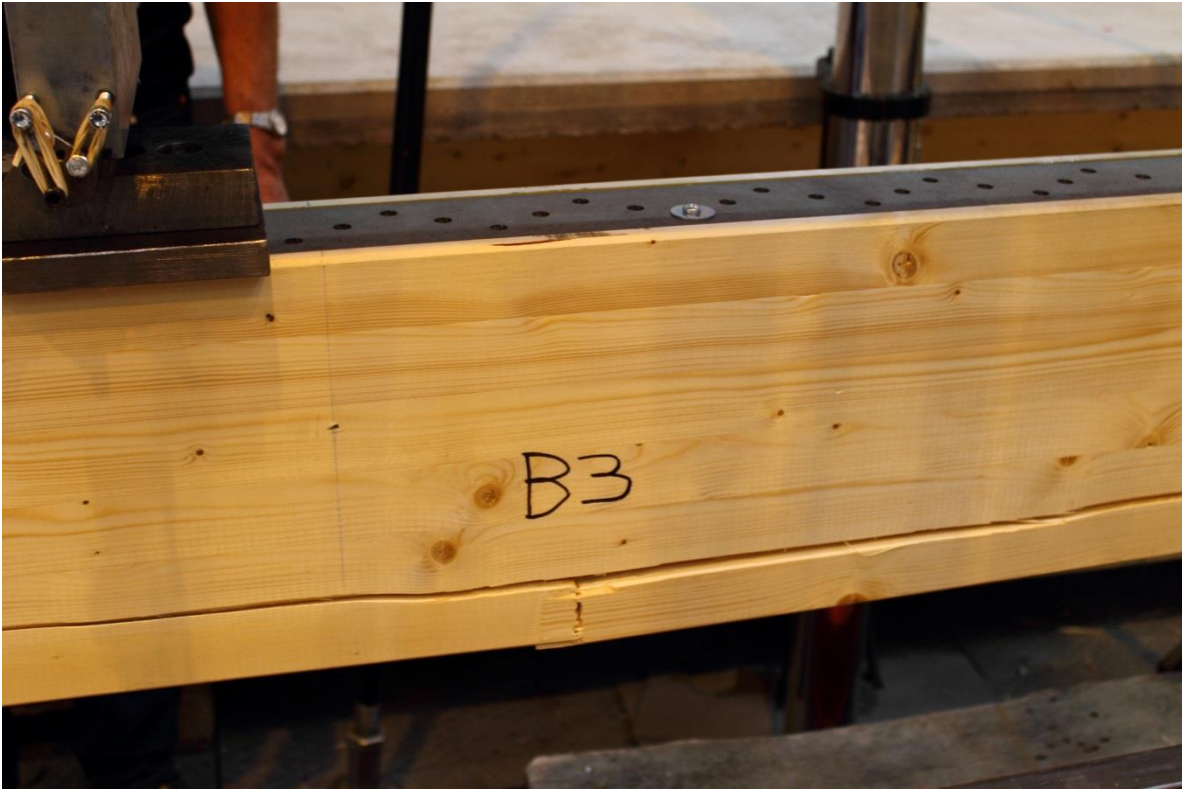
Figur 6.44 – Balk B3, dragbrott i fingerskarv.
