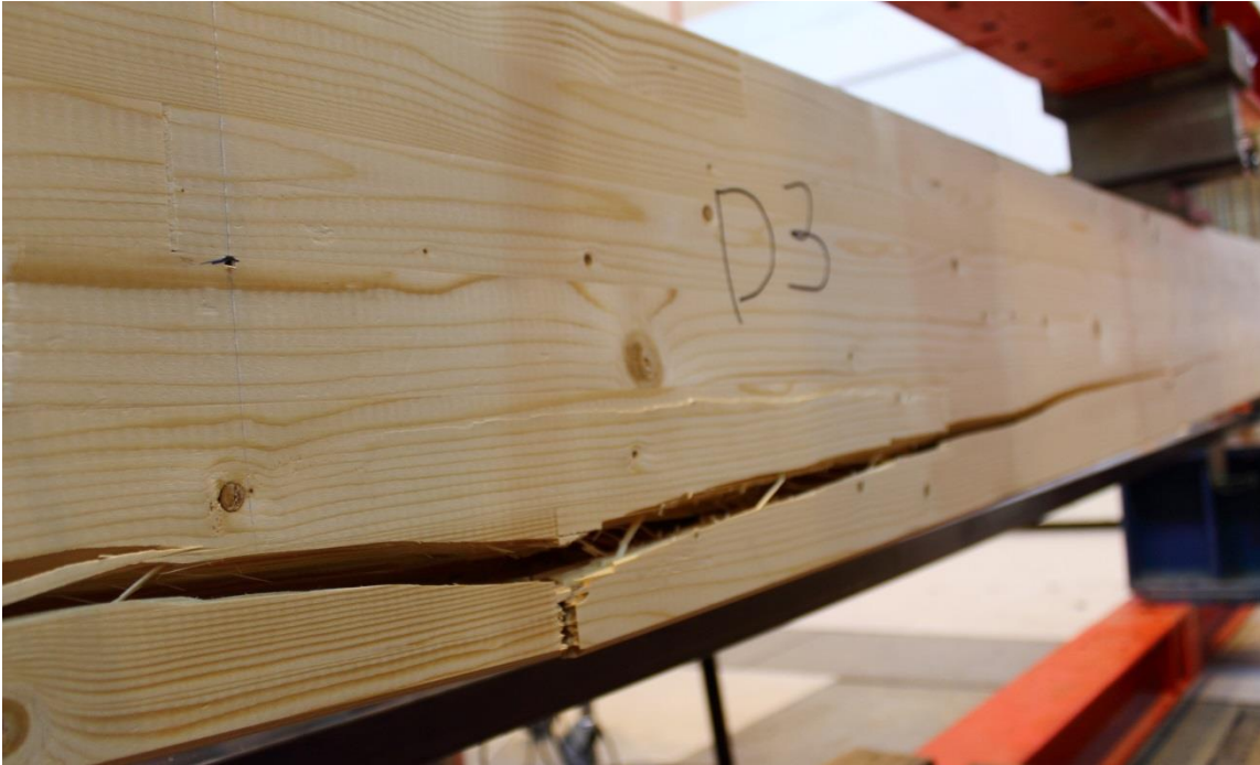
Figur 6.23- Balk D3, dragbrott runt fingerskarv
