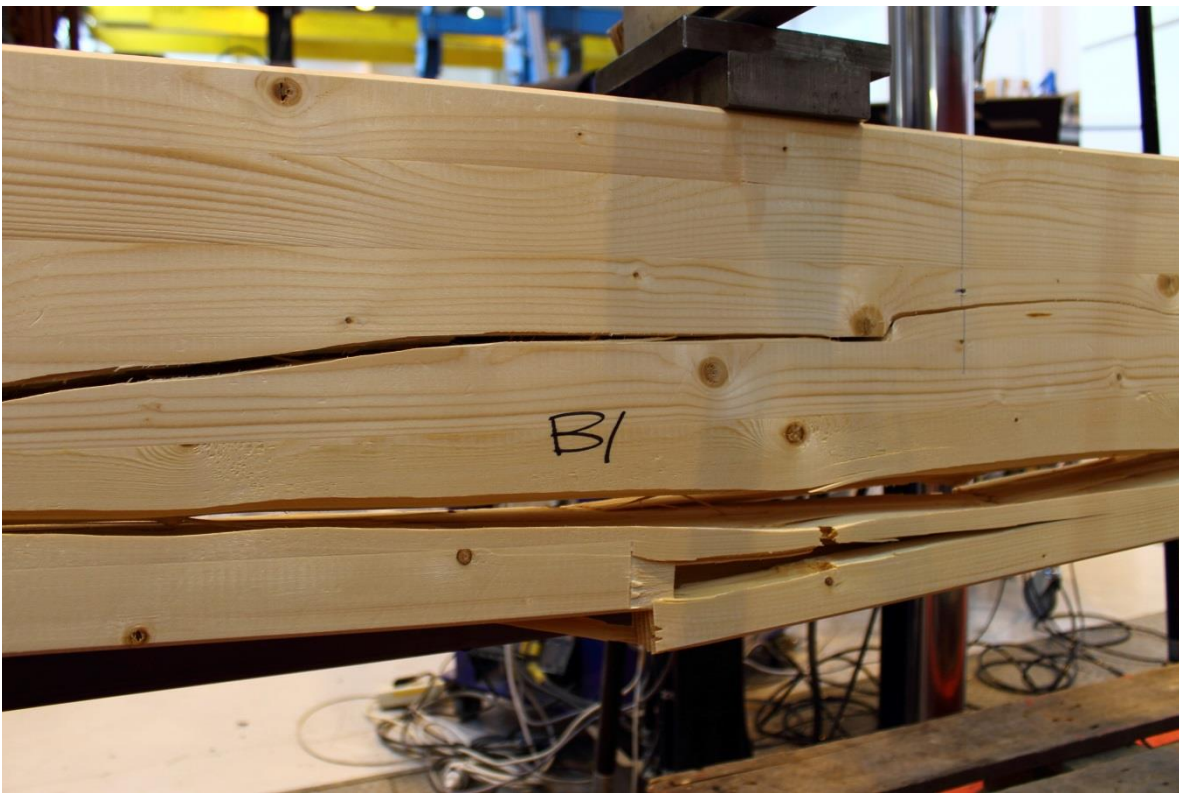
Figur 6.39 – Balk B1, lastinföringspunkt, dragbrott i fingerskarv
