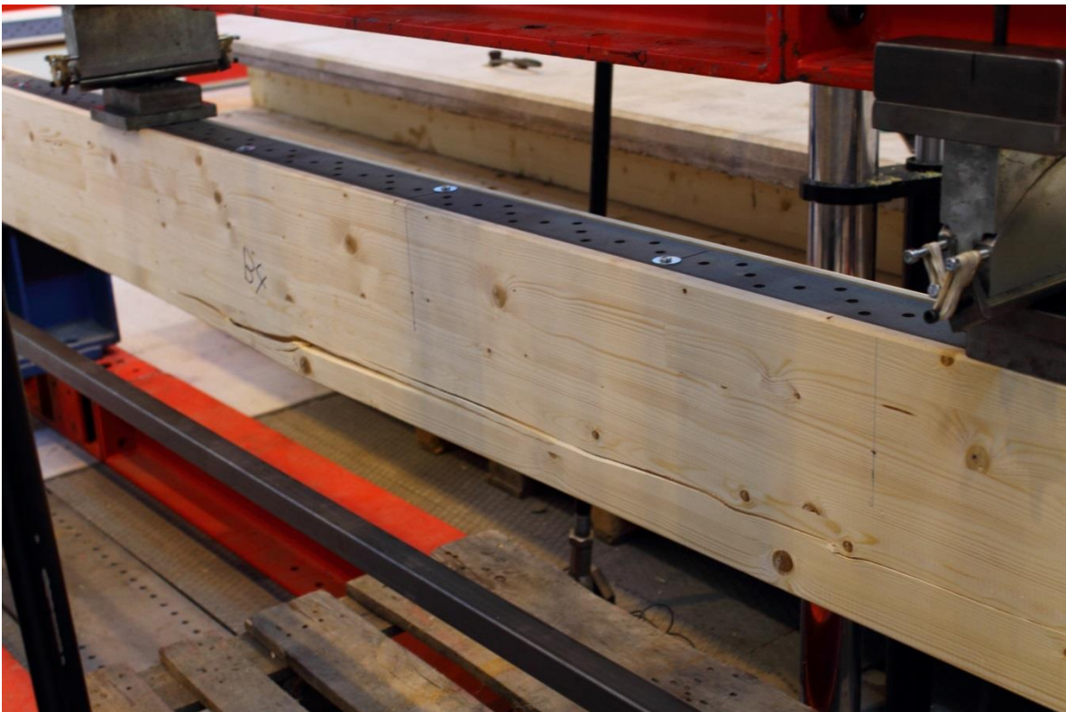
Figur 6.48- Balk B4, dragbrott runt kvist.
