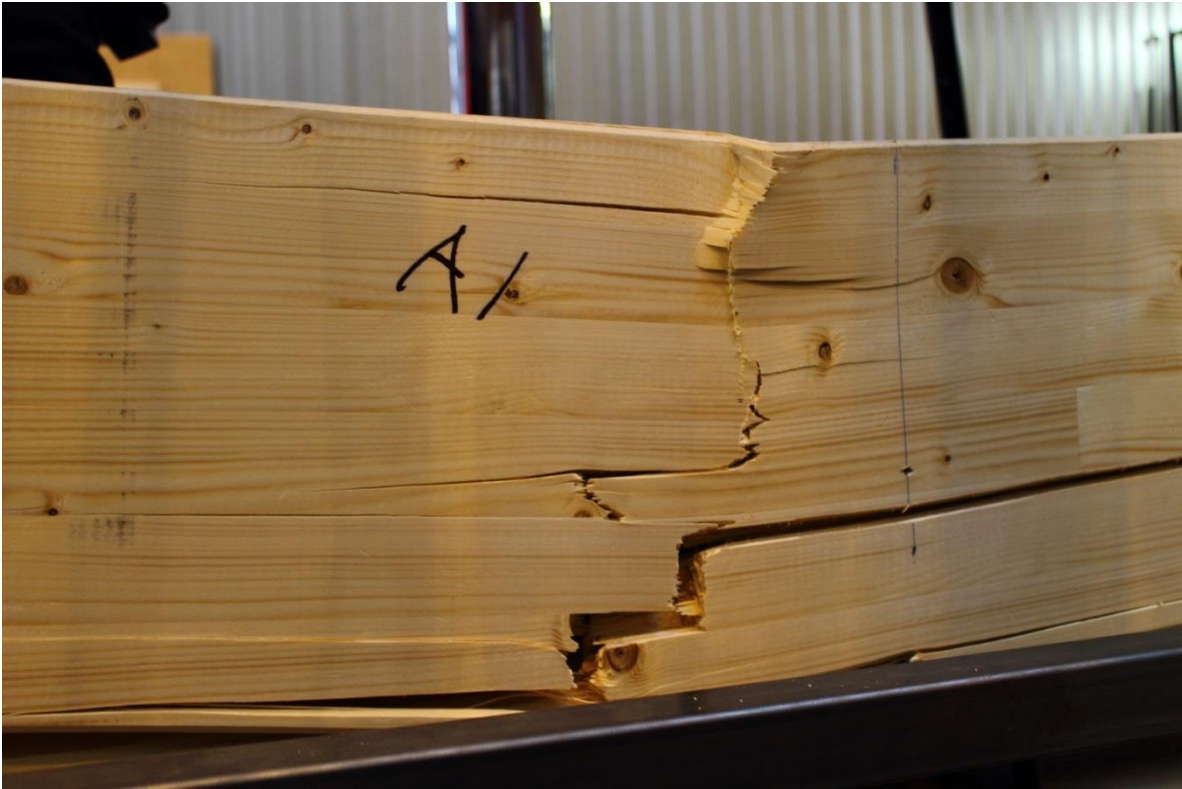
Figur 6.26- Balk A1, tryckbrott i träet.
