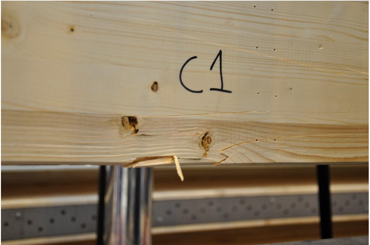
Figur 6.52- Balk C1, dragbrott vid kvist.
