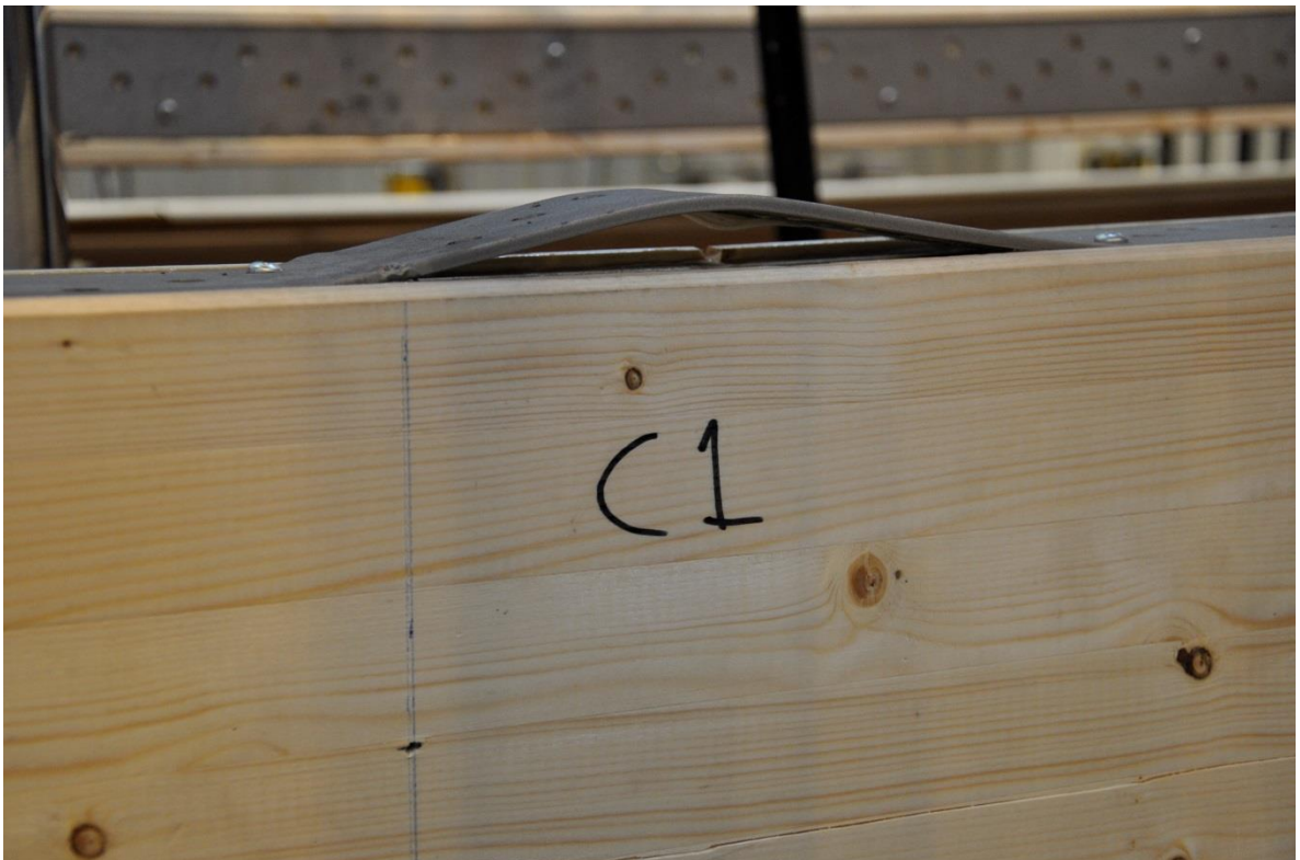
Figur 6.53- Balk C1, buckling av stål.
