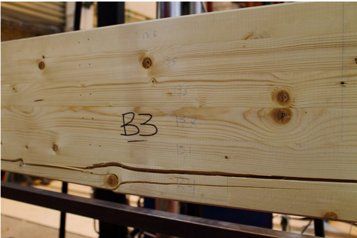
Figur 6.45- Balk B3, dragbrott vid kvist.
