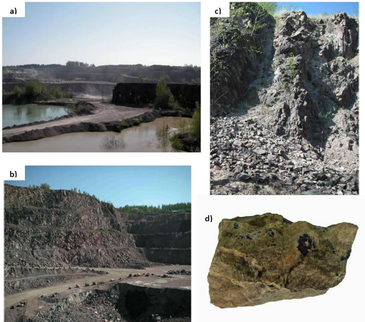
Figur 3. Dalby stenbrott, Lunds kommun. a) Översiktsbild över Dalby stenbrott. b) Bergvägg i gnejsen där brytning skett. c) Sprickzon i gnejsen. d) Gnejs med svart zinkblände hittad i sprickzonen.
