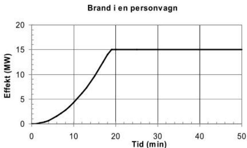
Figur 9. Exempel på tid-effektkurva för stor brand i personvagn. Bild: Banverket, 2007
