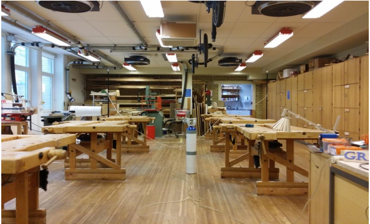
Figur 3.1 Spårgasmätning där fyra stycken mätslangar hängs upp på stativ.
