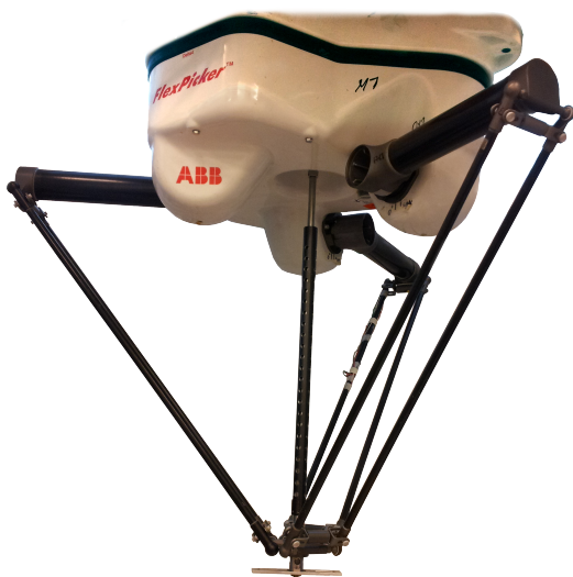
Fig. 1. Den här figuren visar en bild av roboten som användes under det här arbetet. Det är en IRB340 robot från ABB och kallas Flexpicker.
