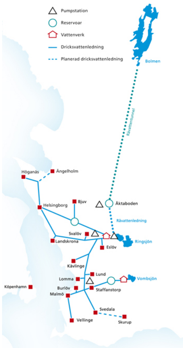
Fig. 3. Ledningsnät (blå linje) från sjö (vattentäkt) via Sydvattnens vattenverk Vombverket och Ringsjöverket, vidare till de delägande kommunerna (Sydvatten, 2014).
