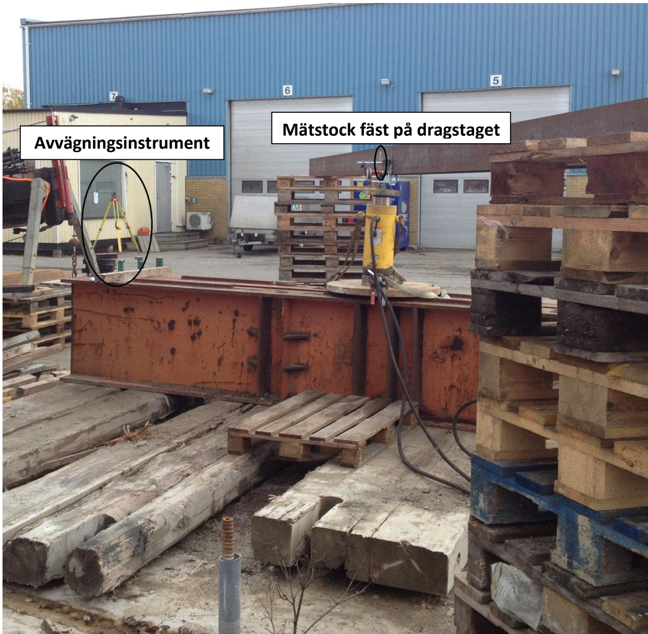
Figur 9. Uppställning med lastfördelande grävmaskinsmattor och balkar, samt en fristående monterad H-balk som mätinstrumenten fästs på (FOTO:Jonas Nilsson).
