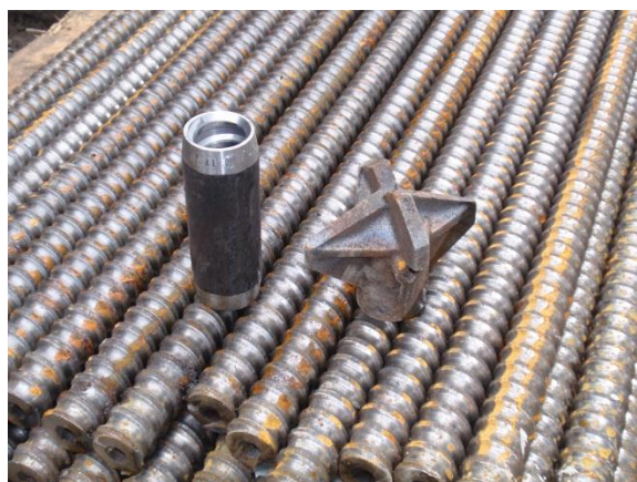
Figur 1. De ihåliga stångarna skarvas med den invändigt gängade skarvhylsan. Den kryssformade borrkronan är anpassad för kohesionsjordar (FOTO: Jonas Nilsson).
