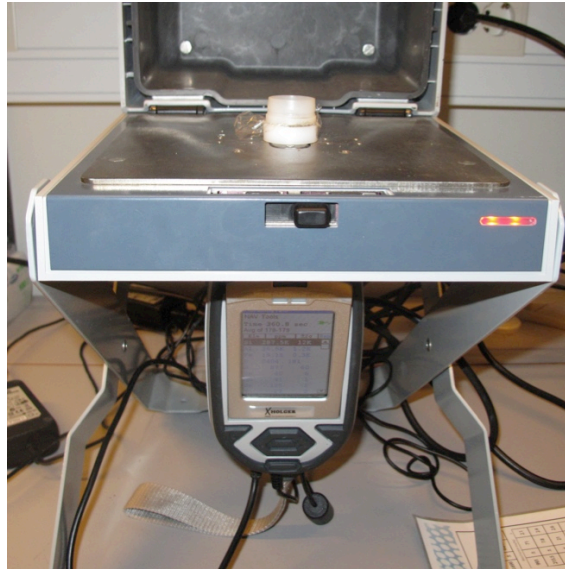
Fig. 15. XRF-analysator och provkopp innehållande jordprov placerat på monteringsbordet.
