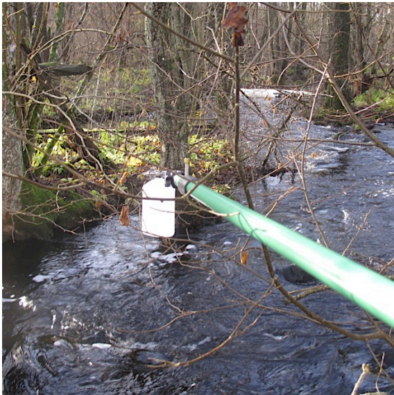
Fig. 12. Bäckvattenhämtare som användes vid vattenprovtagning.
