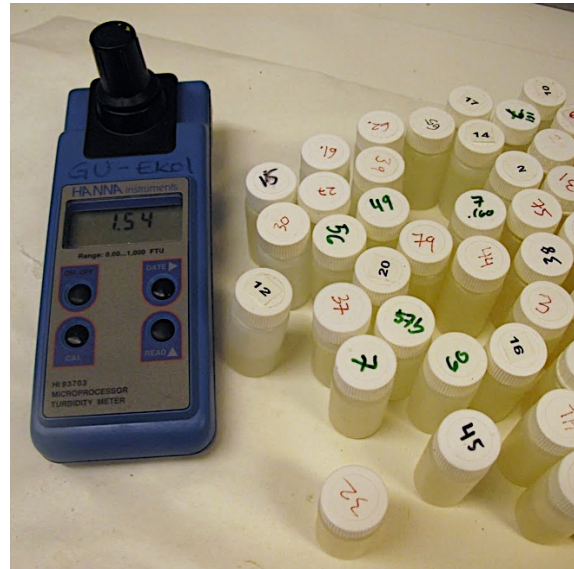
Fig. 13. Turbidometer (till vänster) som användes för att mäta turbiditeten i vattenproverna (till höger).
