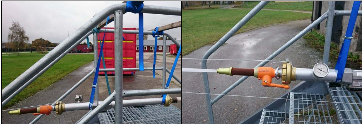
Figur 23. T.v. Systemets upphängning innan munstycket öppnats. T.h. Systemet efter att munstycket öppnats och den resulterande kraften verkar på systemet, det går tydligt att se hur lutningen på upphängningsbandet har förändrats.
