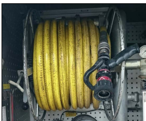
Figur 19. Formstyva slangar i två utföranden som använts för högtrycksmätningar. Båda systemen är fastmonterade i bil och munstycke redan vid instasens start.
