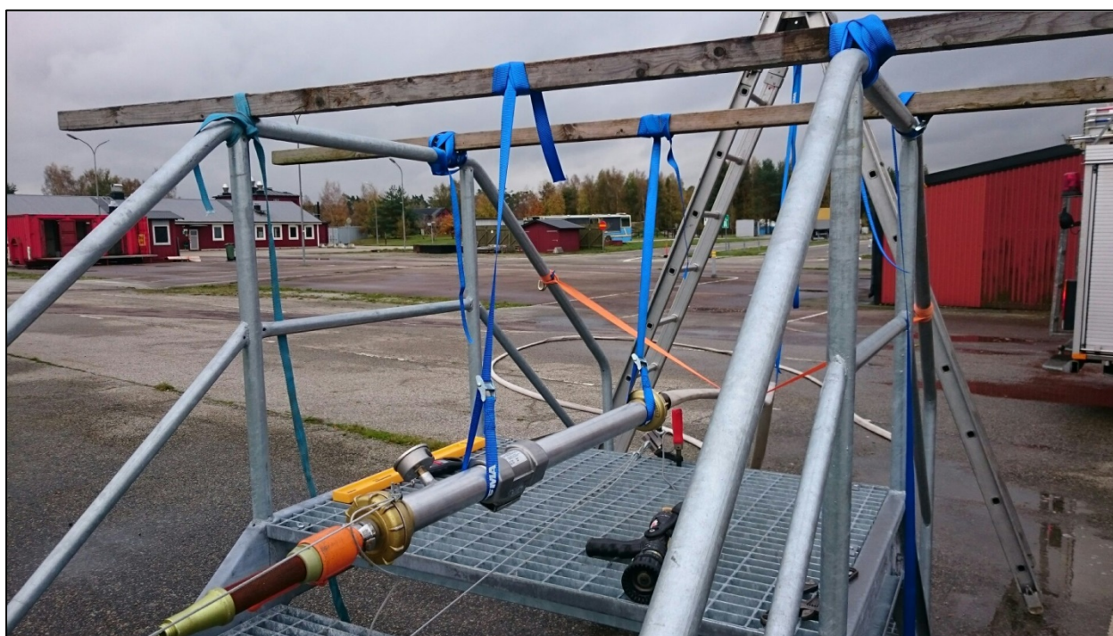
Figur 9. Ställningens stege och trapp som använts vid mätningar ses i bilden. Själva upphängningen av strålrör visas där ett enhetsstrålrör har monterats och hänger förankrad.
