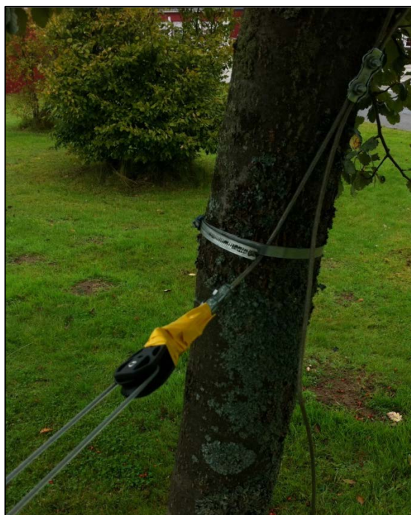
Figur 11. I de två bilderna ser vi hur vajern går från munstycket fram till blocket där riktningen ändras och vajern löper tillbaka till ställningen och lastcellen.
