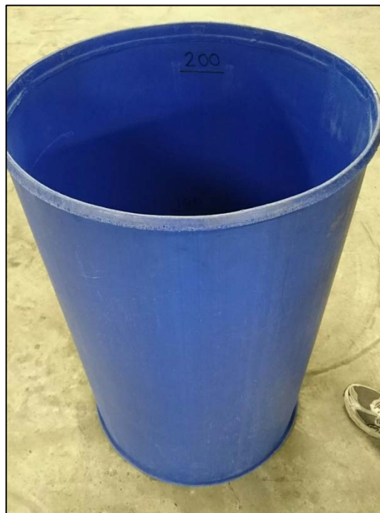
Figur 13. Den 200-liters tunna som används vid bedömningar av flödes hastigheten
