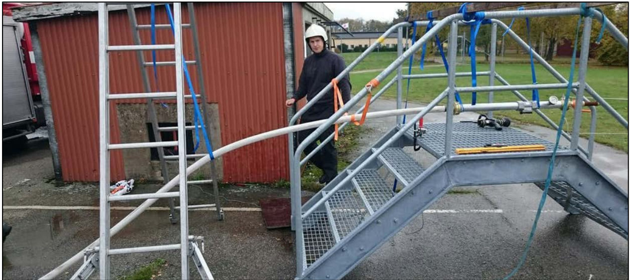
Figur 22. Slangens upphängning illustreras i figuren. Slangen är frilagd från marken några meter bakom strålröret för att sedan gå nedåt mot asfalten.
