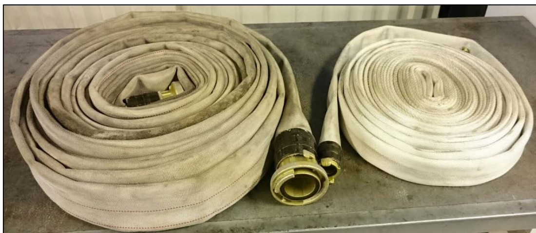
Figur 18. Vävslang i olika dimensioner som använts för mätningar med lågtryckssystem.
