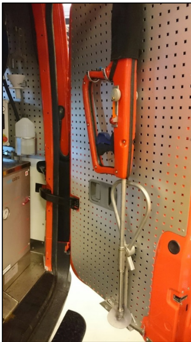
Figur 17. Strålrör som används för högtrycksmätningar. T.v. ser vi en skärsläckare och t.h. ett dimstrålrör av märket Protec.
