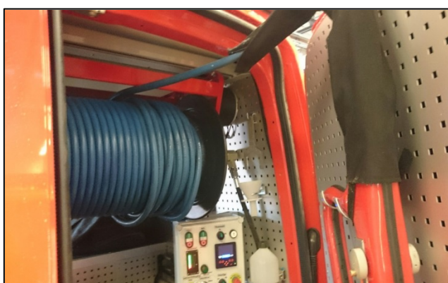
Figur 19. Formstyva slangar i två utföranden som använts för högtrycksmätningar. Båda systemen är fastmonterade i bil och munstycke redan vid instasens start.
