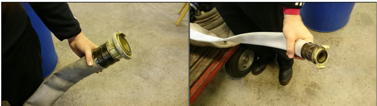
Figur 2. Två olika slangkopplingar som används inom svensk räddningstjänst. T.v. visas en grovslang utrustad med en normalkoppling. T.h. ses en smalslang med tillhörande klokoppling.
