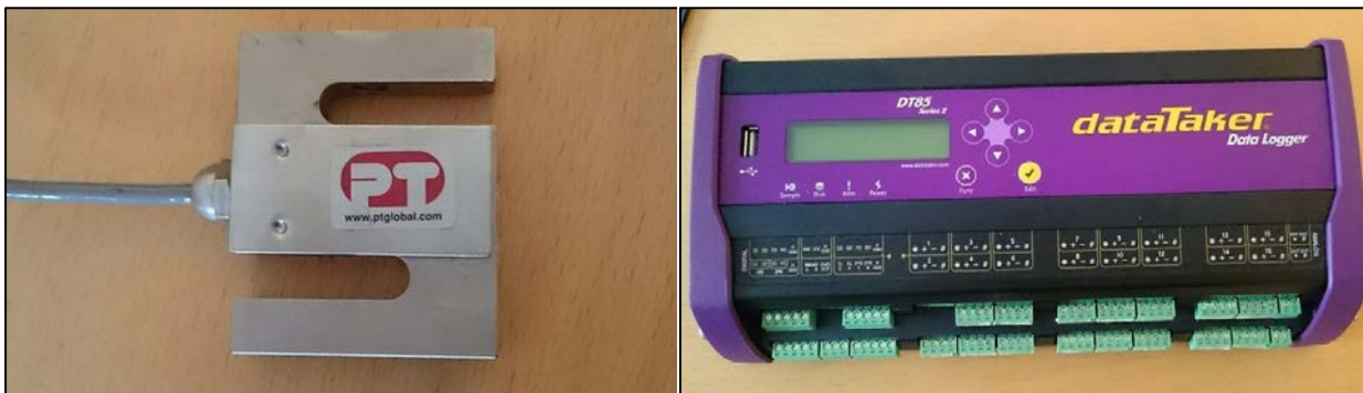
Figur 15. T.v. Den lastcell som använts vid mätningar av reaktionskraften, modell PT4000. T.h. den datalogger som registrerat kraften, modell DT85.
