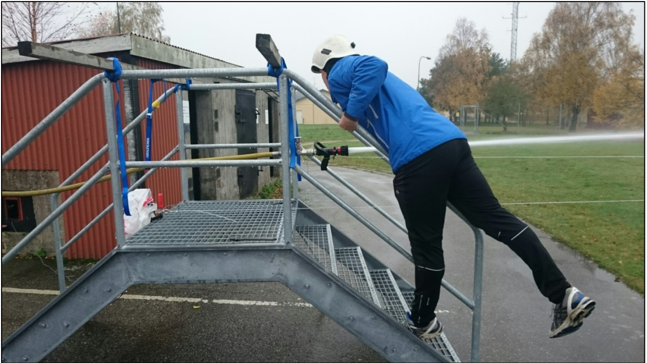
Figur 10. Upphängningen visas från sidan. Bilden är tagen då vattenstrålen ställs in så att den går horisontellt och därmed ger bästa möjliga utslag för reaktionskraften i en dimension.
