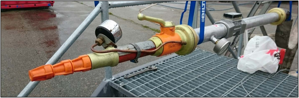
Figur 7. Enhetsstrålrör utrustat med trappmunstycken längst ut som reglerar öppningsdiametern och därmed flödet. De tre stegen har olika diametrar än strålröret och i detta fall erbjuds därmed fyra skiljda inställningar.
