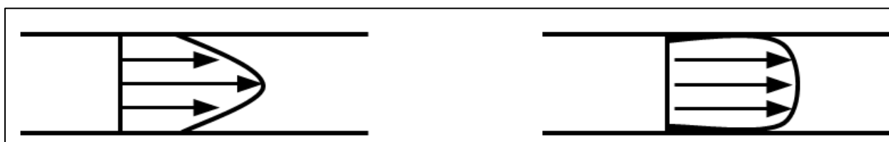
Figur 1. T.v illustreras ett laminärt flöde och T.h kan ett turbulent flöde observeras.
