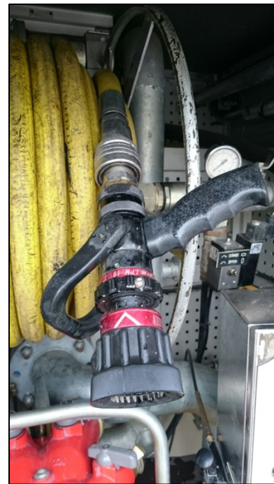
Figur 17. Strålrör som används för högtrycksmätningar. T.v. ser vi en skärsläckare och t.h. ett dimstrålrör av märket Protec.
