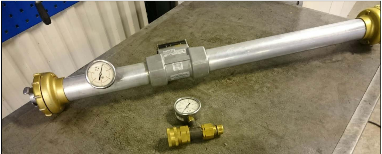
Figur 14. Överst i figuren visas den tryckmätare som använts vid mätningar av lågtryckssystemet och under denna syns den mindre konstruktionen som användes vid mätningar av högtryckssystemet.
