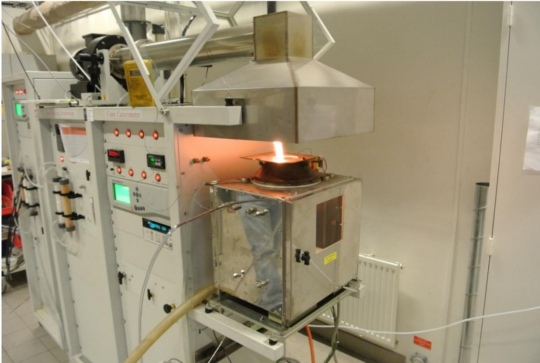
Figur 18. Kammaren placerad under rökgashuven.
