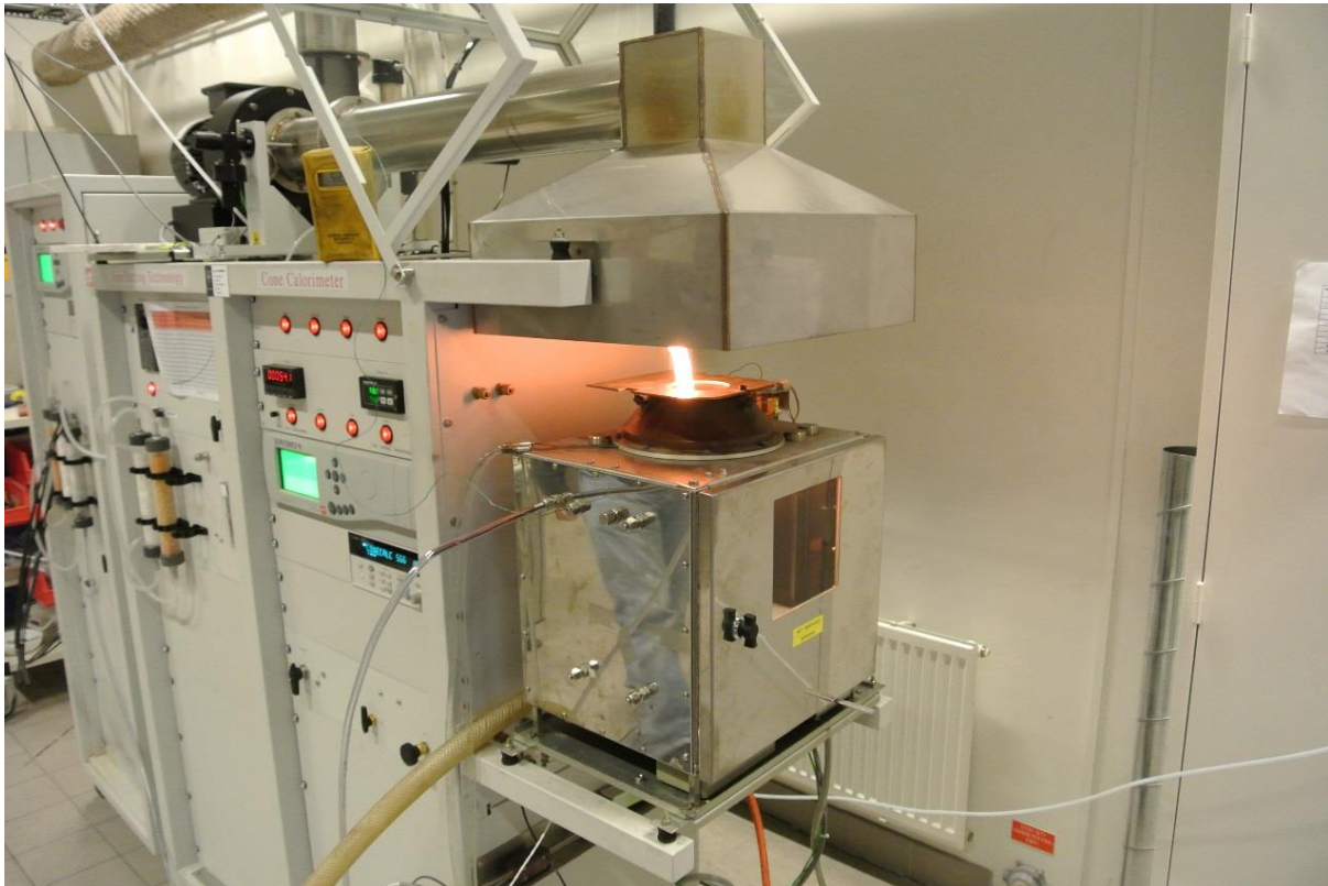
Figur 2. Bild över öppet system med kammare där kammaren är placerad under rökgashuven till konkalorimetern.
