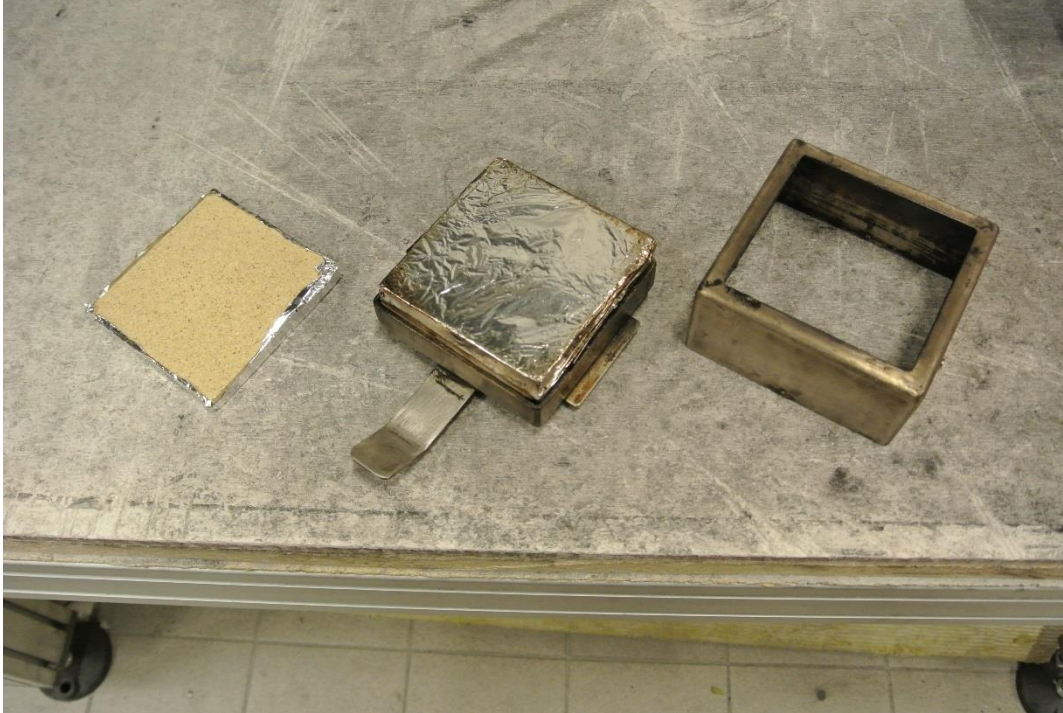
Figur 14. Provmaterialet till vänster inslaget i aluminiumfolie. Till höger ses metallhållarens två delar.
