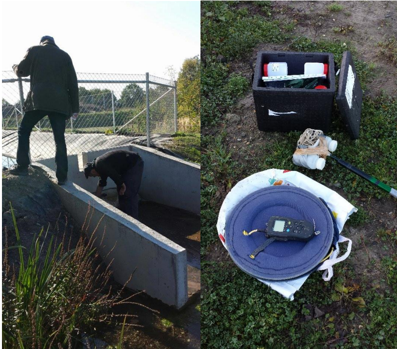
Figur 8. Till vänster: provtagning vid t-stöd mellan reningsdamm 2-3. Till höger: provtagningsutrustning
