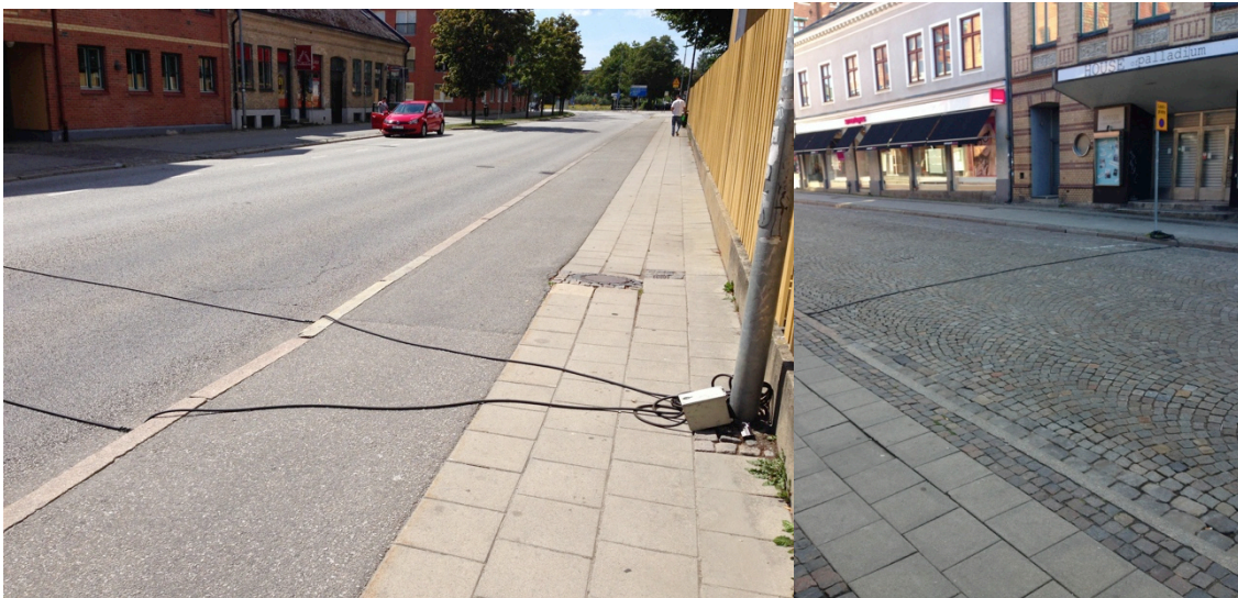
Figur 1 - Pneumatisk slang för motorfordonsmätningar
