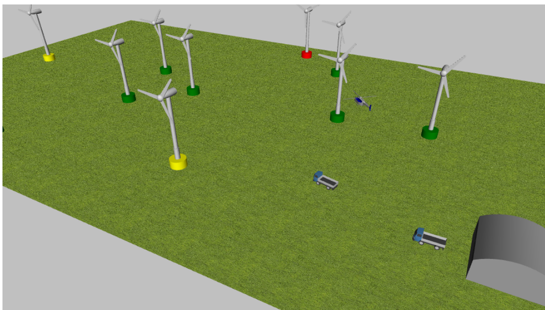
Figur 3-6: Modell över hur ett servicecenter serverar vindkraftverk. Skapad i Anylogic utifrån en guide i programmets hjälpsnitt
