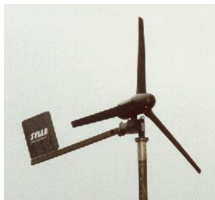
Figur 38: VK240 med effekt på 750 W från SVIAB [50]
