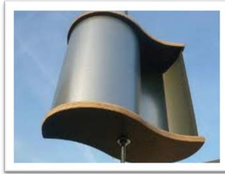
Figur 13: Bild på en Savoniusrotor [36]
