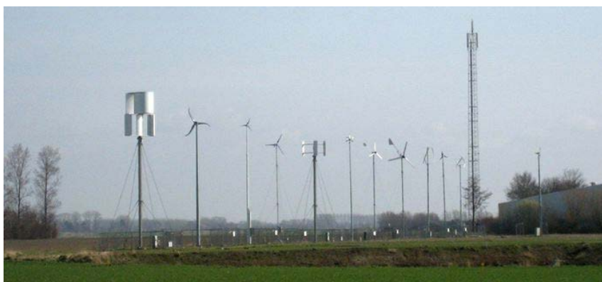
Figur 41: Test av 12 olika små vindkraftverk i Holland under tidsperioden 2008-2009 [51]
