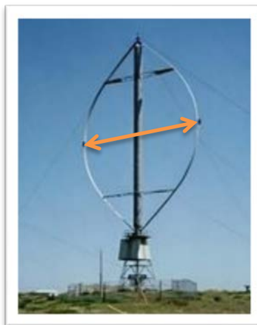
Figur 14: Bild på en Darrieusturbin med 2 blad [36]
