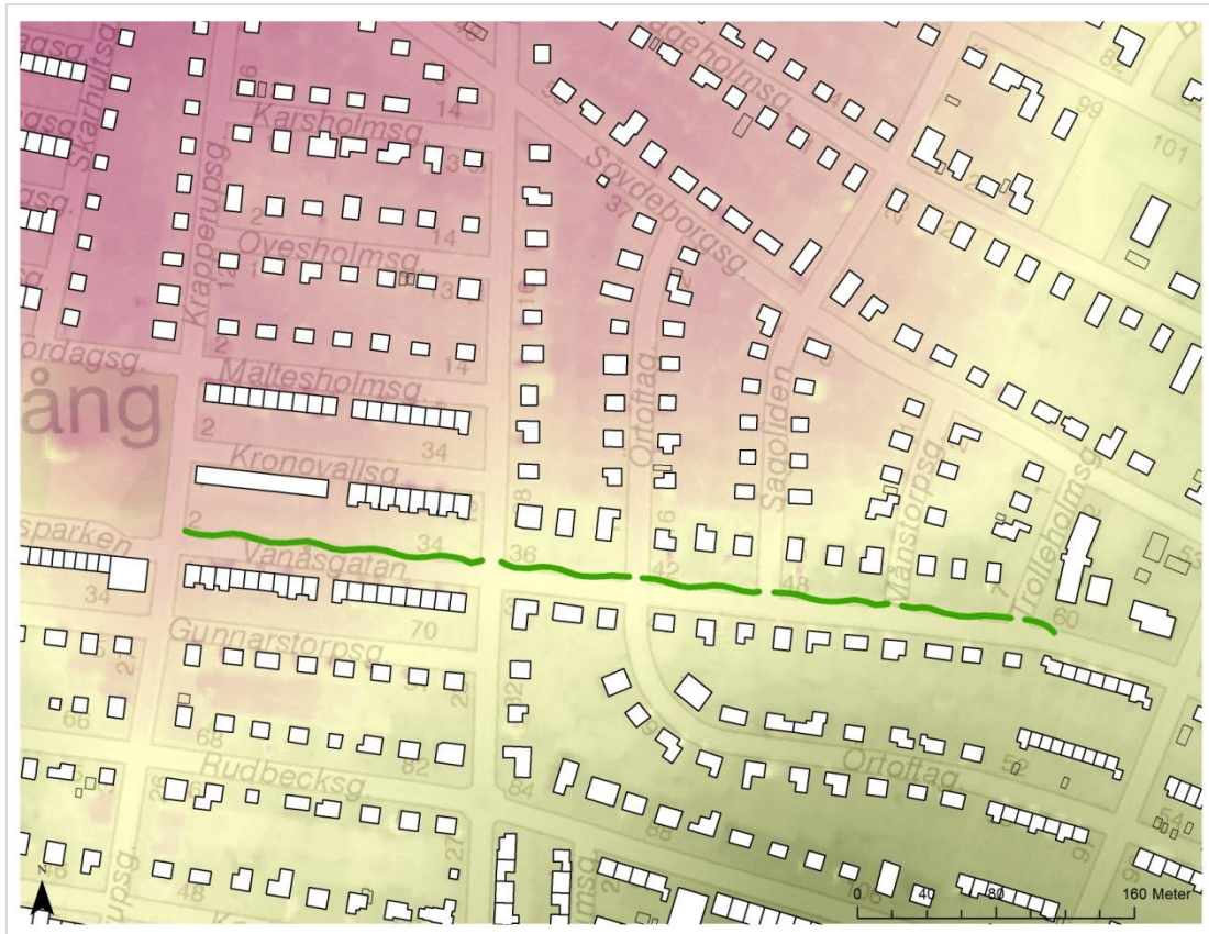
Figur 14. Topografisk översikt över Vanåsgatan och omgivande gator. Lila skuggning innebär lågt liggande gator, det nordvästra hörnet på bilden är beläget cirka +6,5 m ö.h. Grön skuggning betyder att området ligger högre och i det sydöstra hörnet på bilden är marknivån +12,5 m ö.h.
